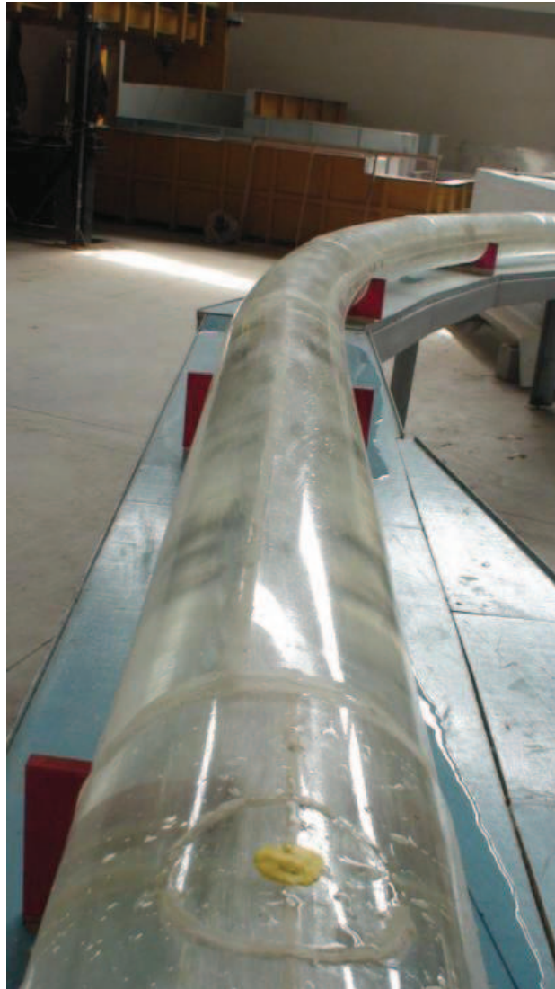
Fotografía No. 47: Túnel de Desvío sin estructura de unión, se observa flujo a tubo lleno para caudal máximo.
