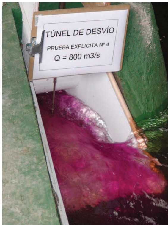
Fotografía No. 84: Vista lateral en la entrada modificada del Túnel de Desvío ( Q_{TD} = 800 \text{ m}^3/\text{s} )
