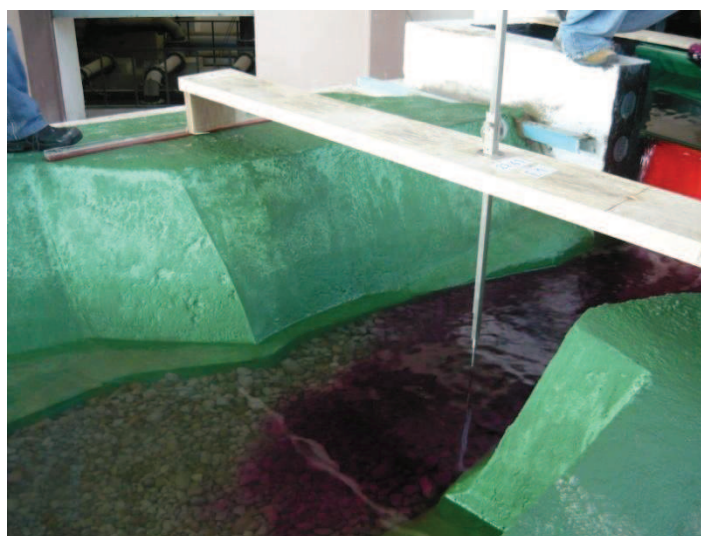
Fotografía No. 20: Limnómetro colocado aguas arriba de la estructura de entrada al Túnel de Desvío
