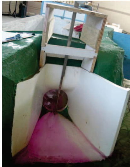
Fotografía No. 21: Limnómetro instalado sobre a la estructura de entrada
