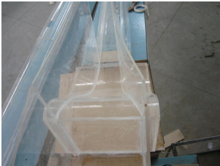
Fotografía No. 5: Montaje de piezas en acrílico.
