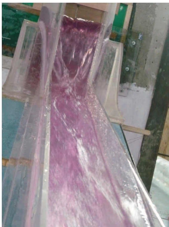
Fotografía No. 27: Flujo a la salida del vertedero Creager en la Descarga Intermedia, Q = 200 \text{ m}^3/\text{s}
