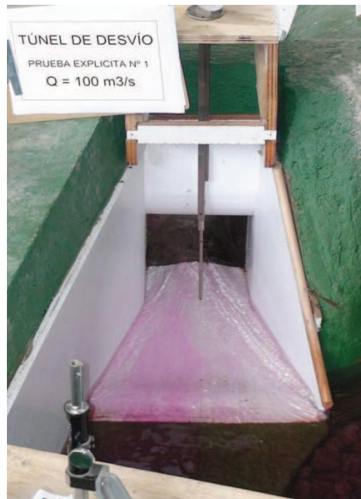
Fotografía No. 121: Comparación entre las diferentes modificaciones de la estructura de entrada, se observa el comportamiento de la misma para Q = 100 \text{ m}^3/\text{s}
