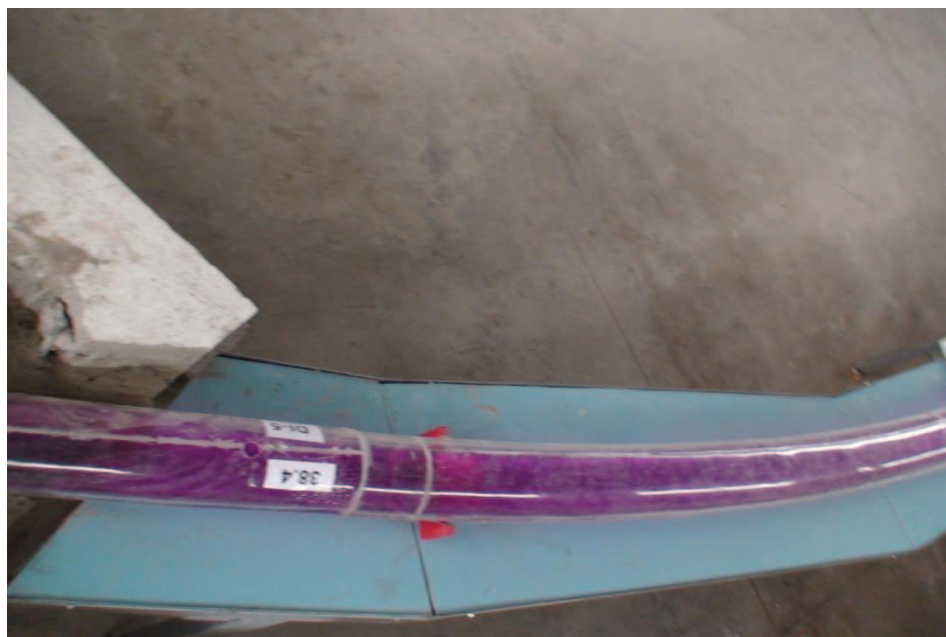
Fotografía No. 79: Vista superior del flujo de la salida en la curva horizontal en la Descarga Intermedia, ( Q_{DI}=200 \text{ m}^3/\text{s} )
