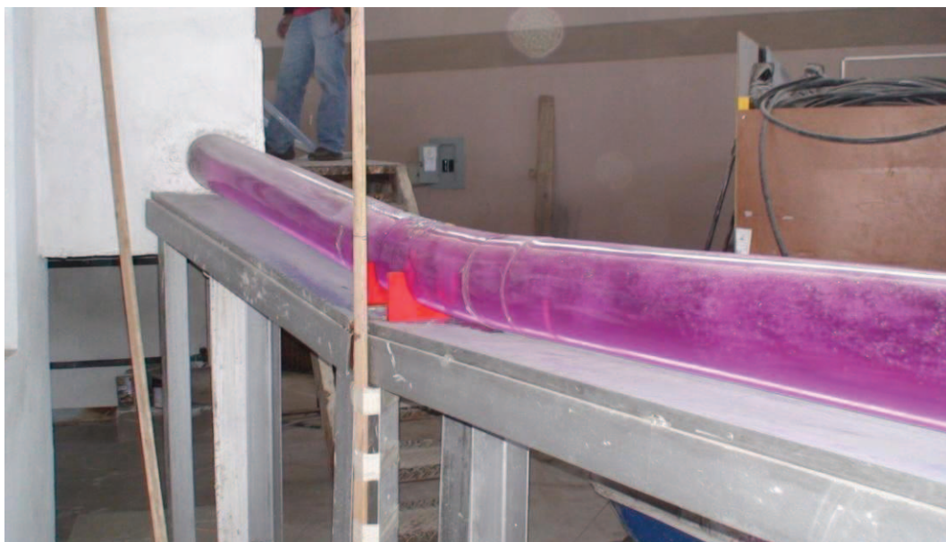
Fotografía No. 49: Flujo a lo largo del Túnel de Desvío durante la prueba de aireación. ( Q_{TD} \approx 1.130 \text{ m}^3/\text{s} ).
