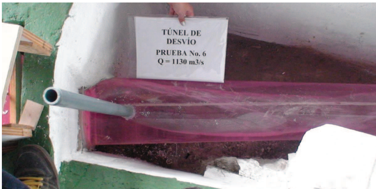
Fotografía No. 47: Funcionamiento del tramo inicial del Túnel de Desvío, luego de la instalación de la estructura de ingreso de aire, Q=1.130 \text{ m}^3/\text{s} .
