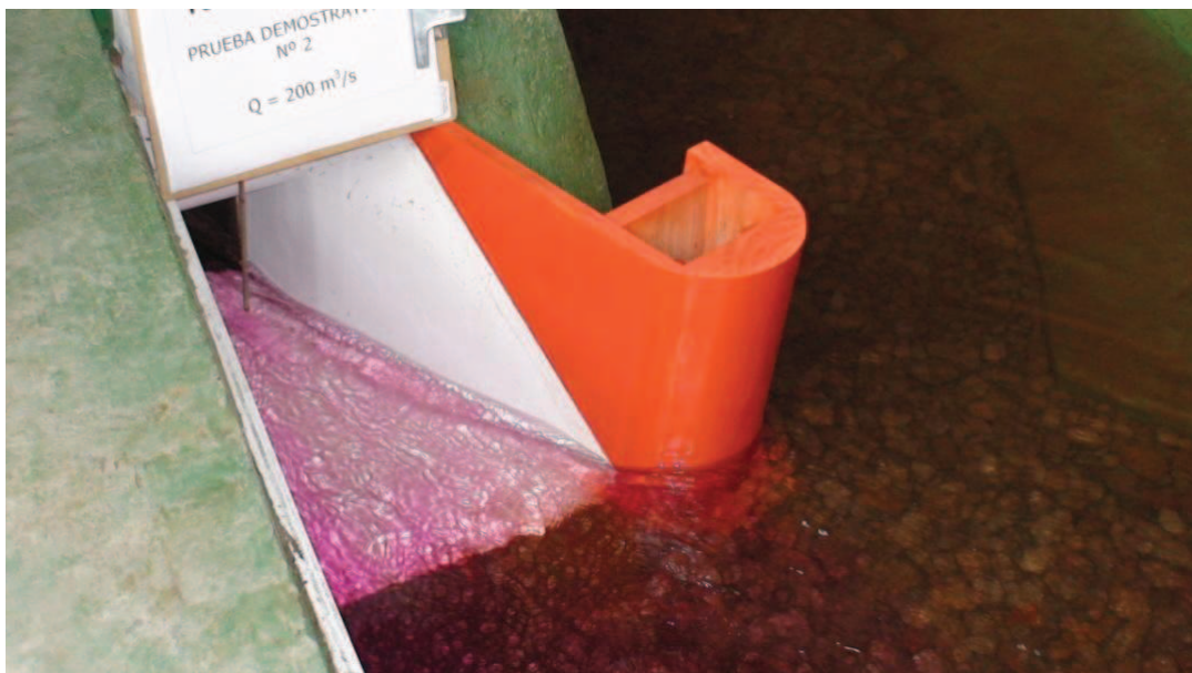
Fotografía No. 88: Vista lateral del flujo en la entrada modificada del Túnel de Desvío. ( Q_{TD} = 200 \text{ m}^3/\text{s} )
