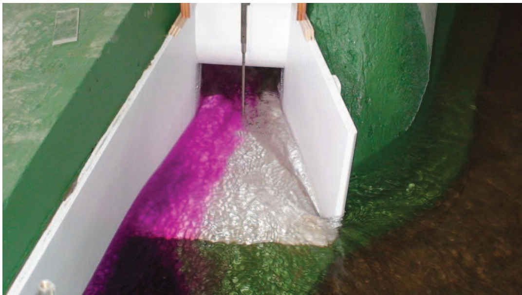
Fotografía No. 60: Vista lateral del flujo en la entrada del Túnel de Desvío,
