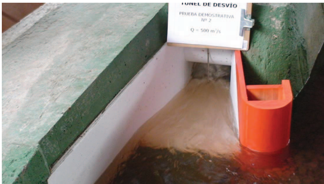
Fotografía No. 89: Vista frontal del flujo en la entrada del Túnel de Desvío ( Q_{TD} = 500 \text{ m}^3/\text{s} )
