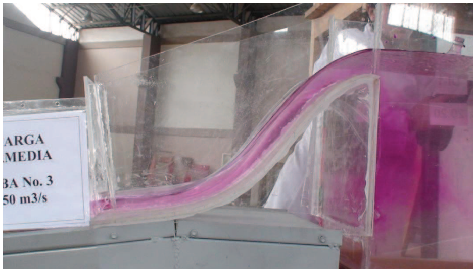
Fotografía No. 88: Comportamiento del flujo sobre el perfil Creager para Q=200 \text{ m}^3/\text{s} (máximo).
