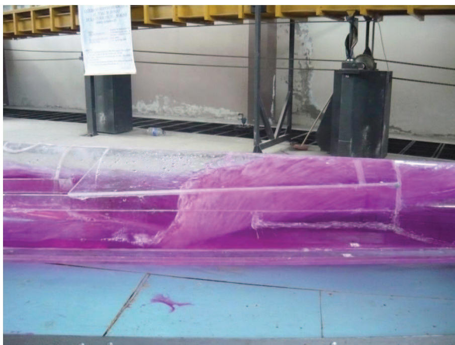
Fotografía No. 12: Funcionamiento del Túnel de Desvío Q=972,10 \text{ m}^3/\text{s} .
