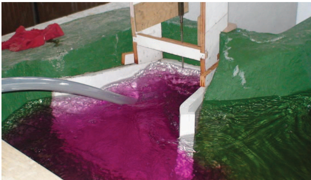
Fotografía No. 44: Vista lateral de la prueba de aireación previa la instalación de estructura de ingreso de aire en la entrada al Túnel de Desvío ( Q_{TD} \approx 1.130 \text{ m}^3/\text{s} )
