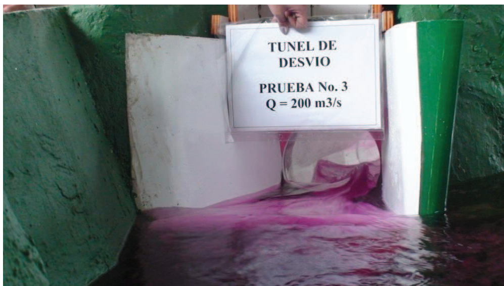
Fotografía No. 40: Vista frontal del estribo derecho modificado: la longitud varía en forma gradual, en dirección de la vertical. Modificación MB-2
