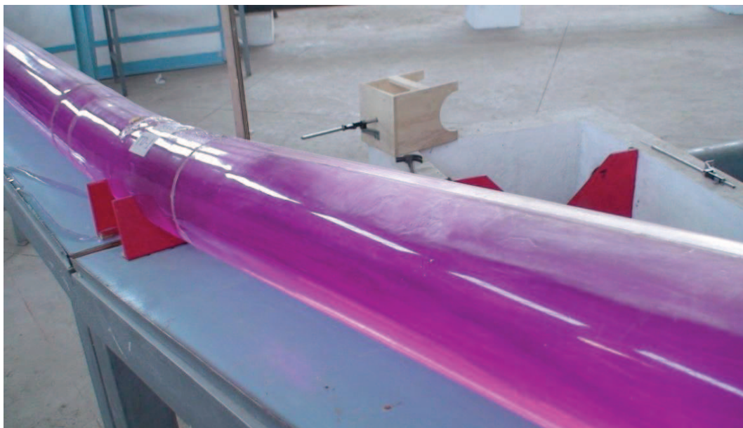
Fotografía No. 48: Flujo a lo largo del Túnel de Desvío durante prueba de aireación. ( Q_{TD} \approx 1.130 \text{ m}^3/\text{s} ).
