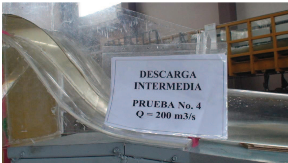
Fotografía No. 88: Comportamiento del flujo sobre el perfil Creager para Q=200 \text{ m}^3/\text{s} (máximo).
