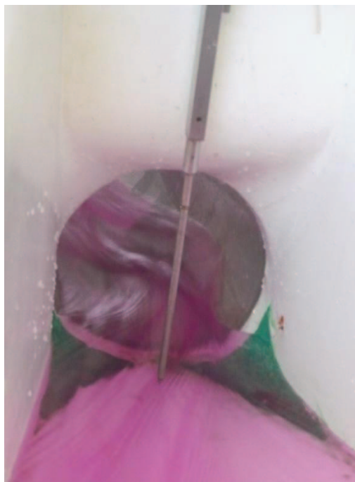
Fotografía No. 8: Flujo en estructura de entrada. Q= 500 \text{ m}^3/\text{s}
