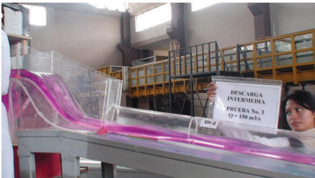
Fotografía No. 75: Vista lateral del flujo en el vertedero y la transición inicial de la Descarga Intermedia, ( Q_{DI}=150 \text{ m}^3/\text{s} )
