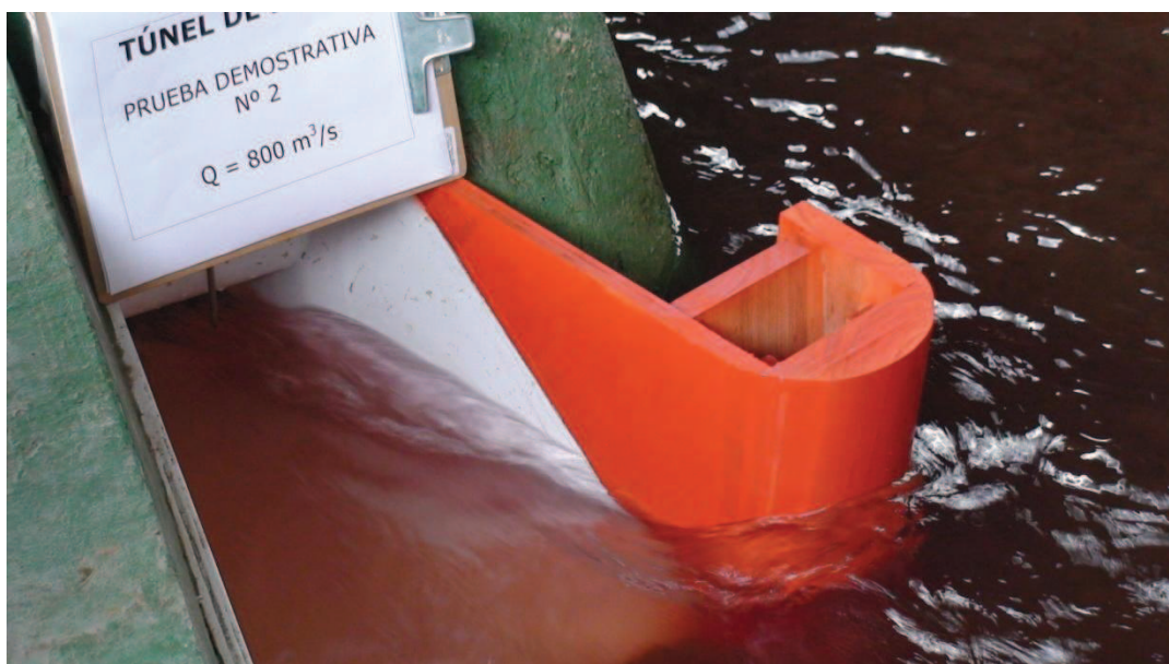
Fotografía No. 90: Vista lateral del flujo en la entrada modificada del Túnel de Desvío. ( Q_{TD} = 800 \text{ m}^3/\text{s} )
