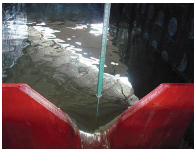
Fotografía No. 19: Limnómetro para medición de la carga sobre el vertedero triangular
