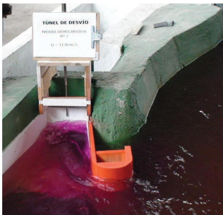
Fotografía No. 91: Vista frontal del flujo en la entrada modificada del Túnel de Desvío. ( Q_{TD} = 1.130 \text{ m}^3/\text{s} )
