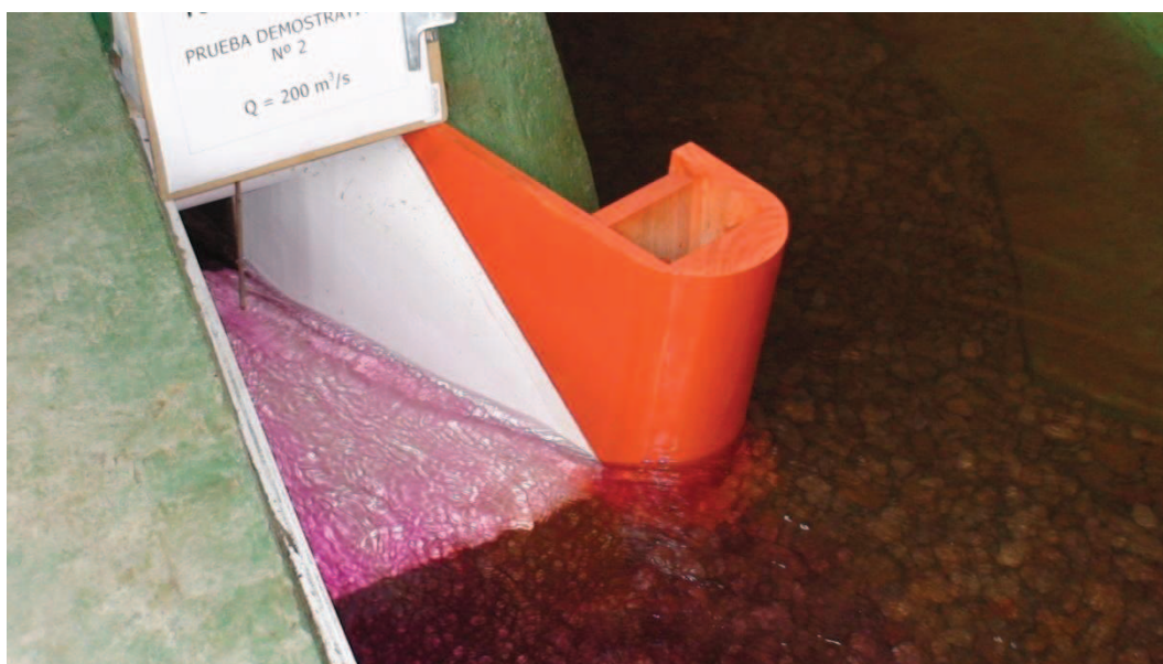
Fotografía No. 115: Se observa una pequeña sobre-elevación del flujo junto a la pared lateral. No se observa un efecto de contracción en el extremo inicial del muro. ( Q=200 \text{ m}^3/\text{s} ).
