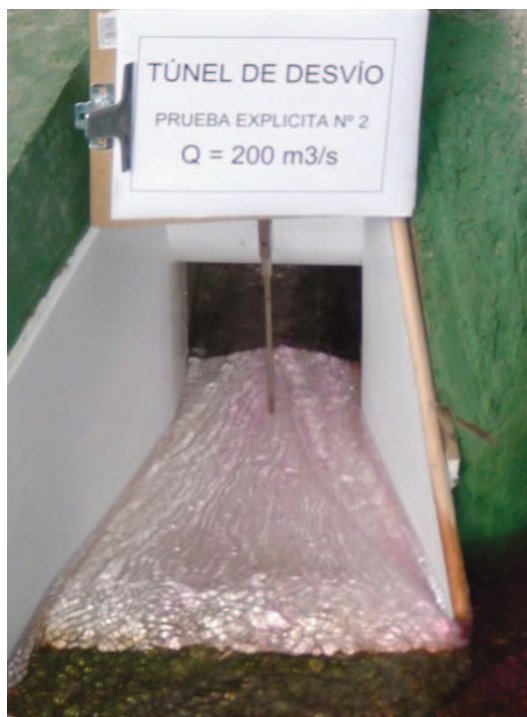
Fotografía No. 98: Se observa una aproximación asimétrica del flujo provocada por la onda que se inicia en el extremo del estribo derecho. ( Q=200 \text{ m}^3/\text{s} ).
