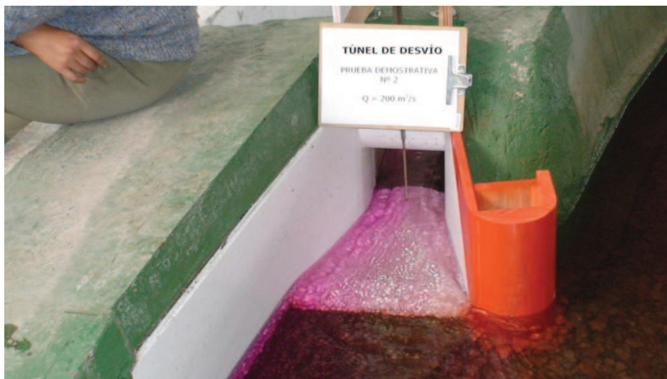
Fotografía No. 115: Se observa una pequeña sobre-elevación del flujo junto a la pared lateral. No se observa un efecto de contracción en el extremo inicial del muro. ( Q=200 \text{ m}^3/\text{s} ).
