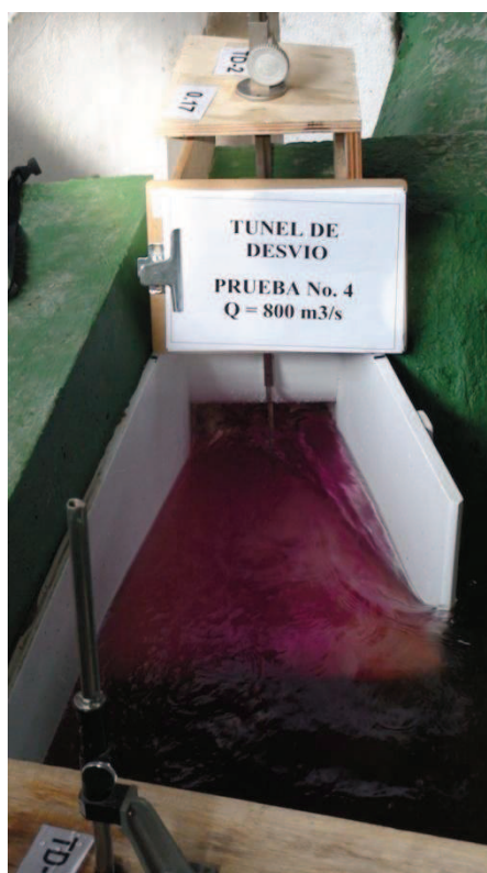
Fotografía No. 62: Vista frontal del flujo en la entrada del Túnel de Desvío, ( Q_{TD}=800 \text{ m}^3/\text{s} )
