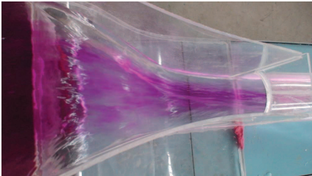
Fotografía No. 74: Vista superior del flujo en el vertedero. ( Q_{DI}=150 \text{ m}^3/\text{s} )
