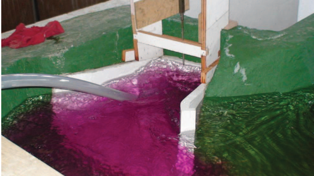
Fotografía No. 65: Introducción de manguera de ventilación en la transición del Túnel de Desvío para caudal superior a 950 \text{ m}^3/\text{s} .
