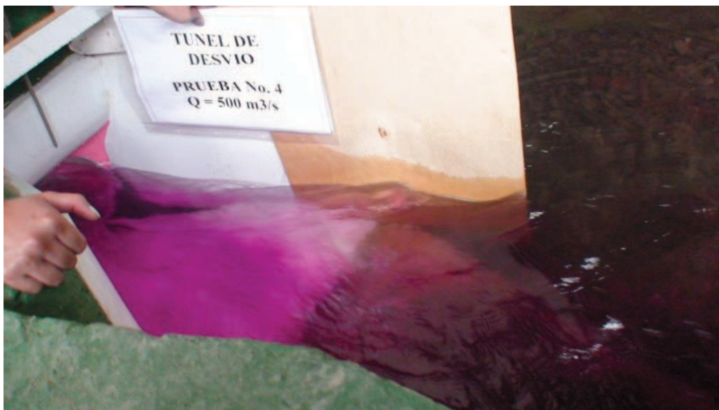
Fotografía No. 42: Aparecen pequeñas fluctuaciones de la superficie libre para el flujo junto al estribo derecho, para el caudal de Q= 500 \text{ m}^3/\text{s} . El estribo es recto. Modificación MB-3
