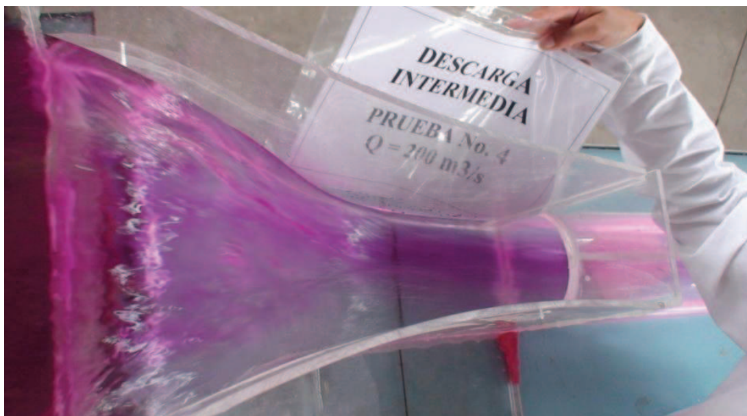
Fotografía No. 77: Flujo de entrada del vertedero en la Descarga Intermedia, ( Q_{DI}=200 \text{ m}^3/\text{s} )
