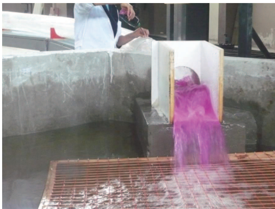
Fotografía No. 16: Flujo a la salida del Túnel de Desvío para Q_{DI} = 100 \text{ m}^3/\text{s} .
