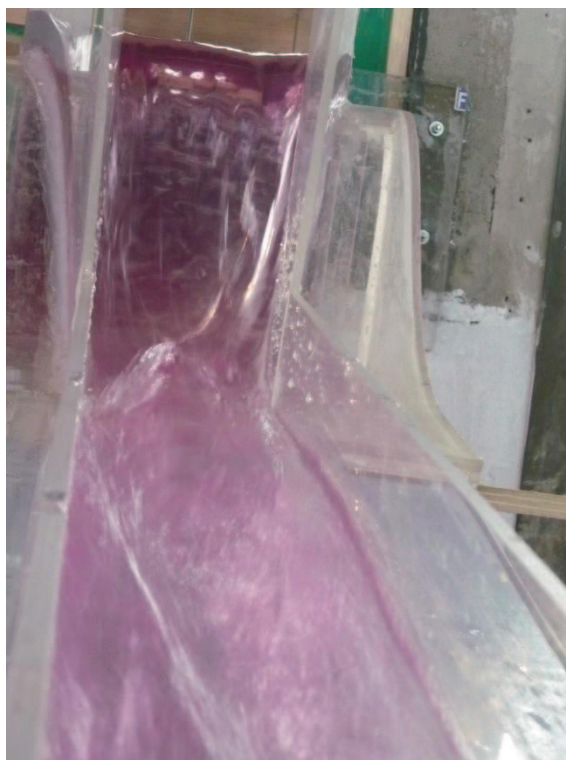
Fotografía No. 26: Flujo a la salida del vertedero tipo Creager en la Descarga Intermedia, Q = 100 \text{ m}^3/\text{s} .
