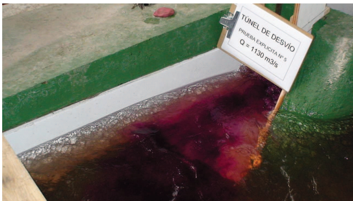
Fotografía No. 85: Comportamiento del flujo en la entrada modificada del Túnel de Desvío. ( Q_{TD} = 1.130 \text{ m}^3/\text{s} )
