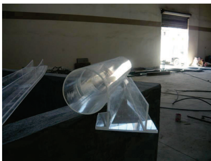
Fotografía No. 12: Estructura de unión de la Descarga Intermedia y Túnel de Desvío
