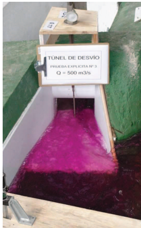
Fotografía No. 123: Comparación entre las diferentes modificaciones de la estructura de entrada, se observa el comportamiento de la misma para Q = 500 \text{ m}^3/\text{s}
