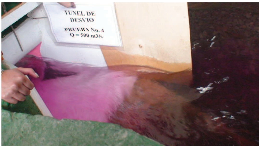
Fotografía No. 39: Funcionamiento de la estructura con alargamiento del estribo. Q=500 \text{ m}^3/\text{s} .
