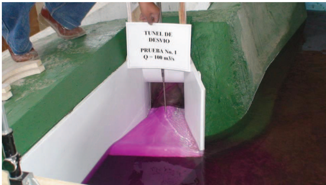
Fotografía No. 53: Vista lateral del ingreso de flujo a la bocatoma, ( Q_{TD}=100 \text{ m}^3/\text{s} )
