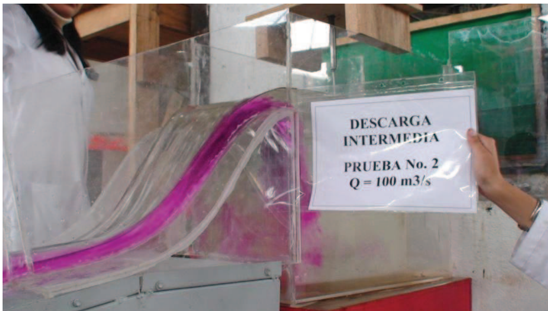
Fotografía No. 70: Vista del flujo en el vertedero tipo Creager. ( Q_{DI}=100 \text{ m}^3/\text{s} )
