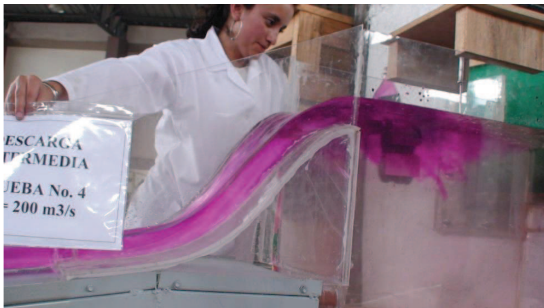
Fotografía No. 76: Flujo de entrada del vertedero en la Descarga Intermedia, ( Q_{DI}=200 \text{ m}^3/\text{s} )
