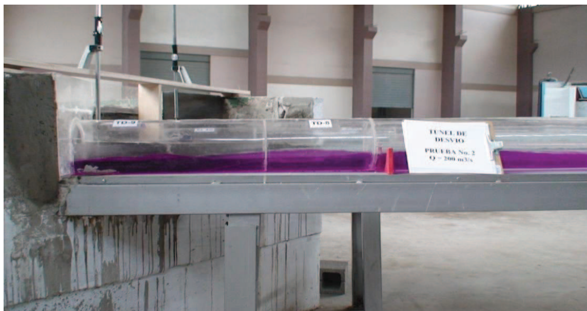
Fotografía No. 58: Vista del flujo en la transición de salida del Túnel de Desvío, ( Q_{TD}=200 \text{ m}^3/\text{s} ).
