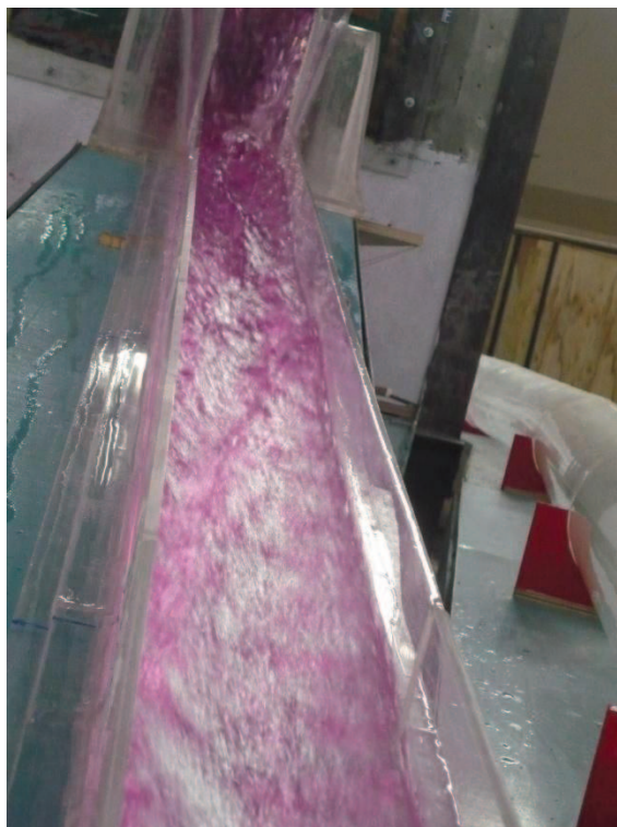
Fotografía No. 28: Flujo en el canal de la Descarga Intermedia, Q = 200 \text{ m}^3/\text{s} .
