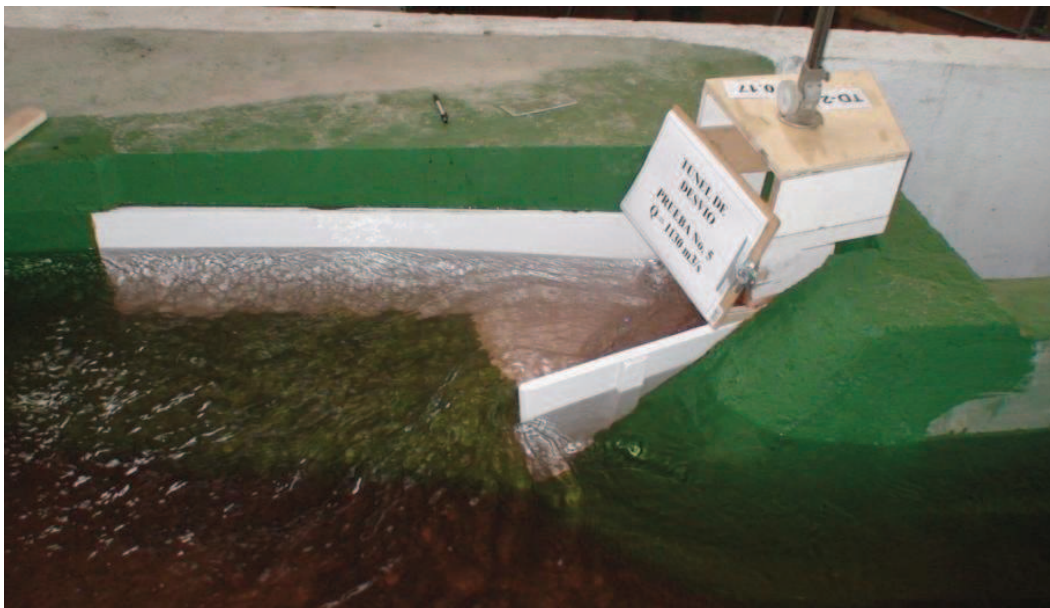
Fotografía No. 67: Vista lateral del flujo de entrada al Túnel de Desvío, ( Q_{TD}=1.130 \text{ m}^3/\text{s} )
