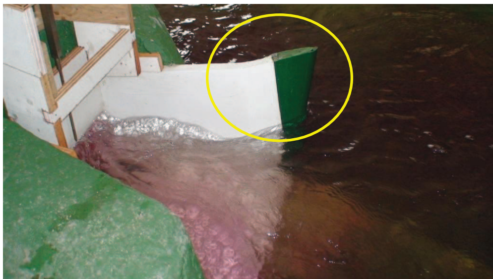
Fotografía No. 40: Vista frontal del estribo derecho modificado: la longitud varía en forma gradual, en dirección de la vertical. Modificación MB-2
