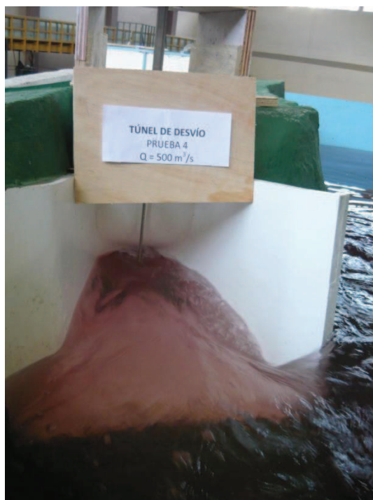
Fotografía No. 8: Flujo en estructura de entrada. Q= 500 \text{ m}^3/\text{s}
