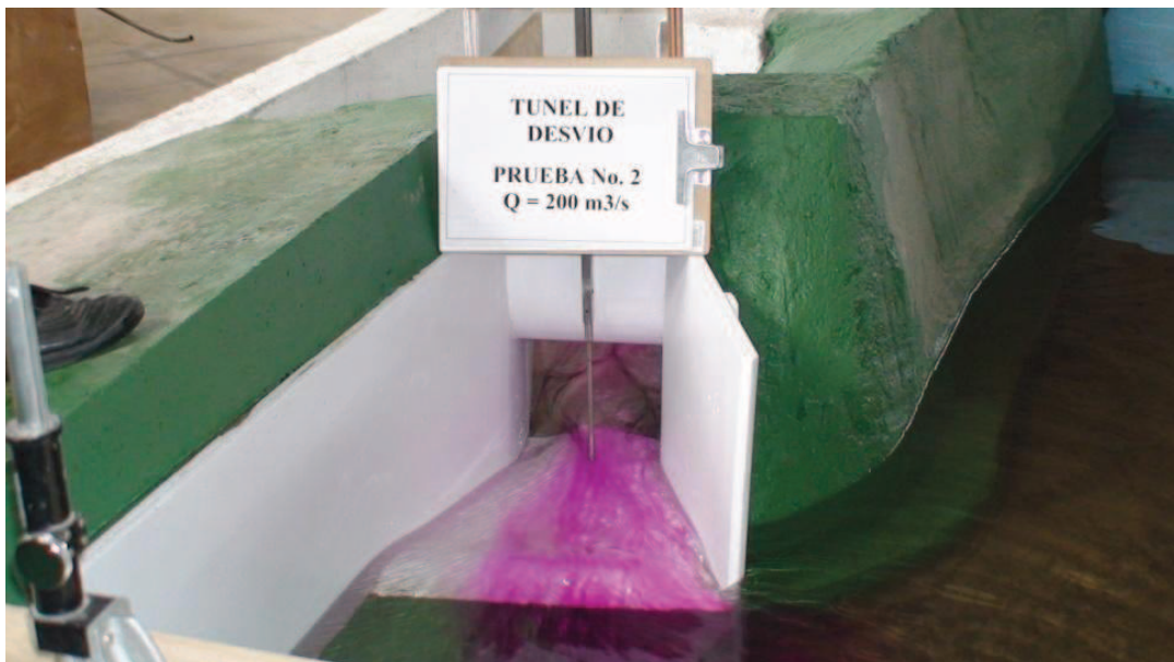
Fotografía No. 56: Vista frontal del flujo de entrada al Túnel de Desvío, ( Q_{TD}=200 \text{ m}^3/\text{s} ).
