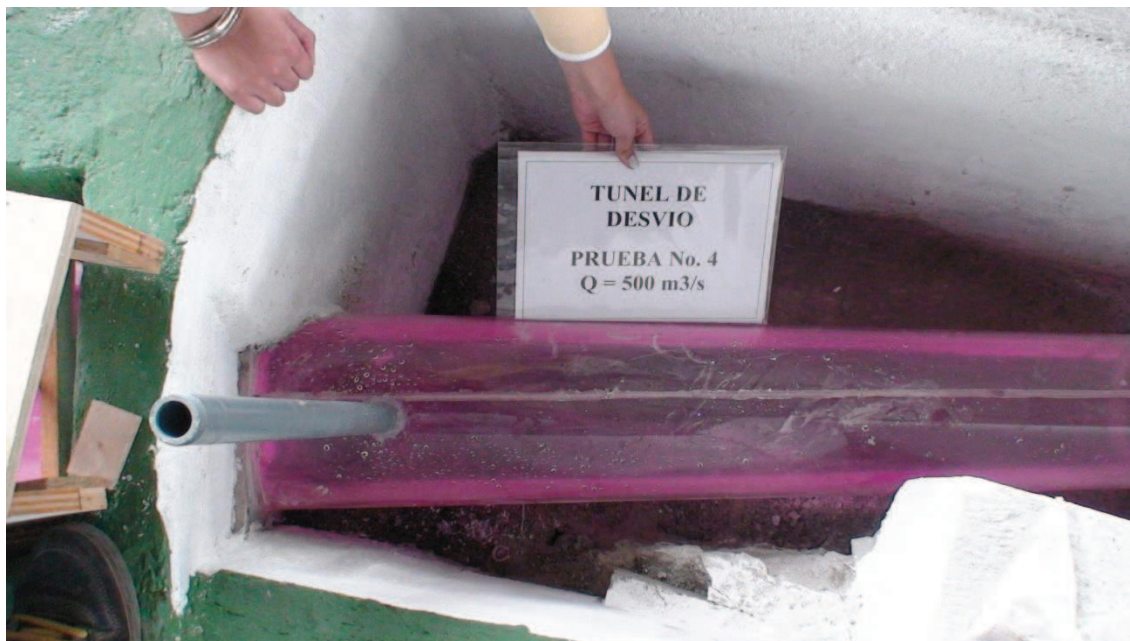
Fotografía No. 46: Funcionamiento del tramo inicial del Túnel de Desvío, luego de la instalación de la estructura de ingreso de aire, Q=500 \text{ m}^3/\text{s} .
