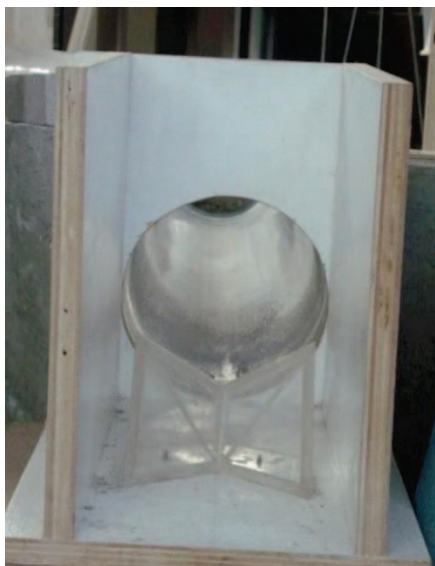
Fotografía No. 7: Modelo del dissipador Tipo Kumin ubicado al extremo del Túnel de Desvío
