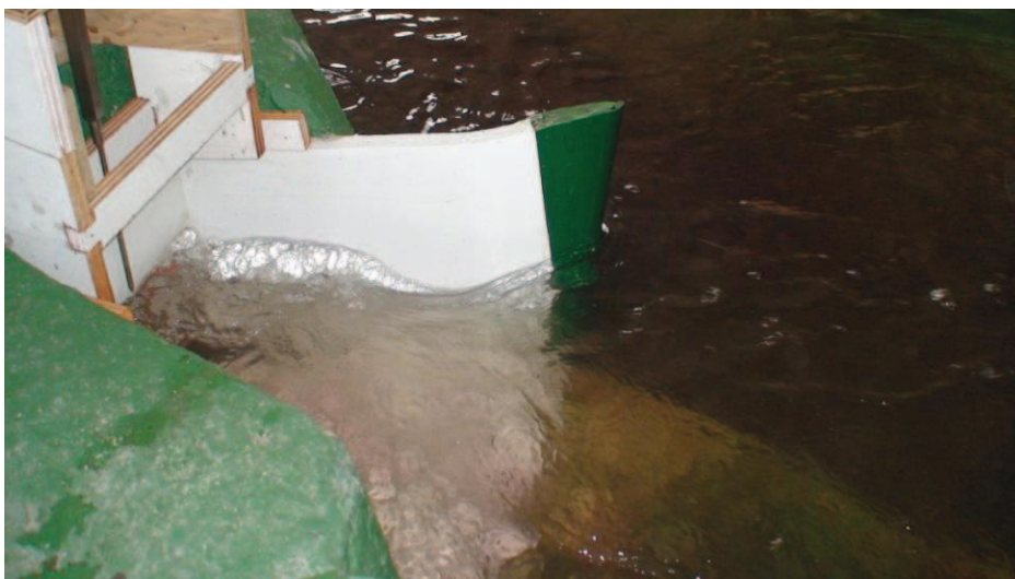
Fotografía No. 43: Flujo inadecuado en el extremo derecho por la curvatura en la pared. Modificación MB-2
