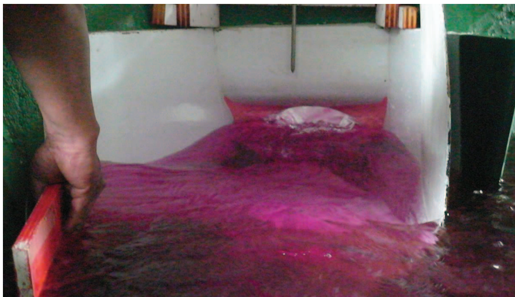
Fotografía No. 41: Funcionamiento de la estructura de ingreso con el estribo izquierdo alargado.
