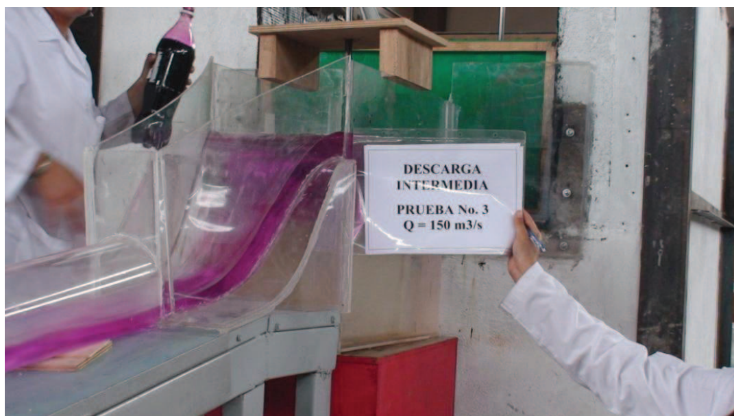
Fotografía No. 73: Vista del flujo en el vertedero de la Descarga Intermedia, ( Q_{DI}=150 \text{ m}^3/\text{s} )
