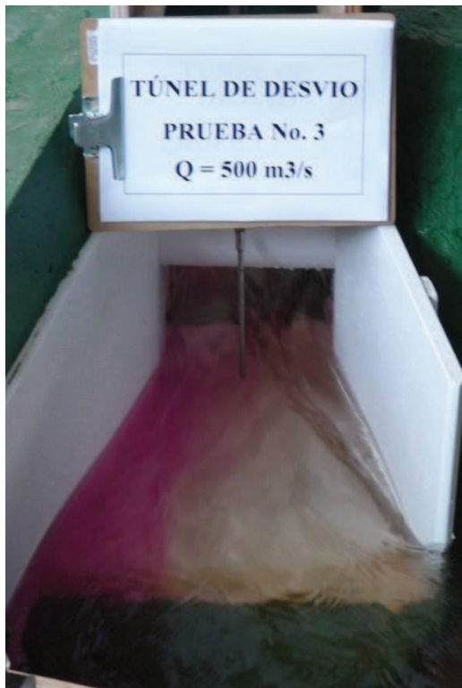
Fotografía No. 123: Comparación entre las diferentes modificaciones de la estructura de entrada, se observa el comportamiento de la misma para Q = 500 \text{ m}^3/\text{s}
