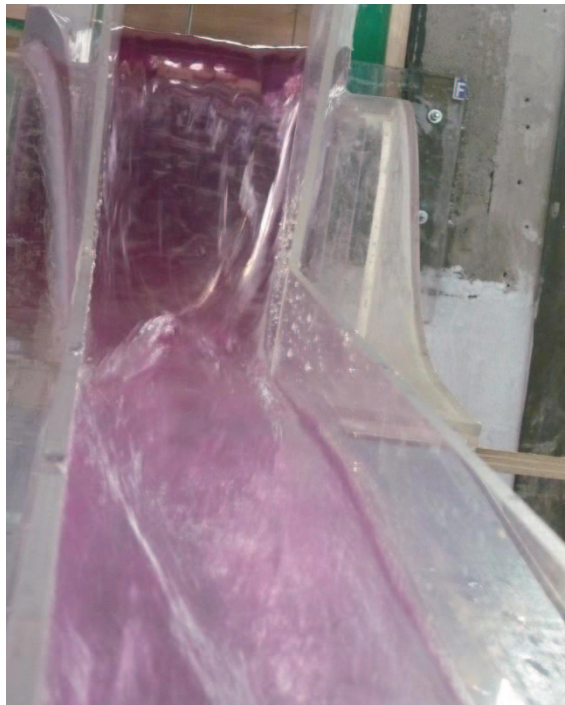
Fotografía No. 14: Formación de ondas aguas abajo del vertedero.
