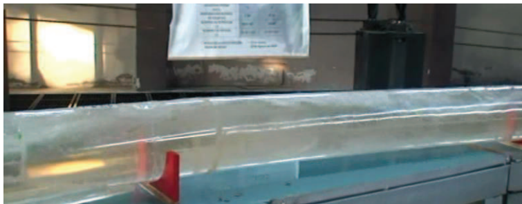
Fotografía No. 34: Flujo a la salida de la estructura de unión con flujo combinado: Q_{TD} = 898,0 \text{ m}^3/\text{s} y Q_{DI} = 102,53 \text{ m}^3/\text{s} . Se observa la generación de ondas.
