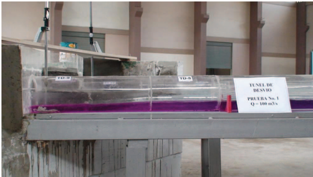
Fotografía No. 55: Vista del flujo en la transición de salida del Túnel de Desvío, ( Q_{TD}=100 \text{ m}^3/\text{s} )
