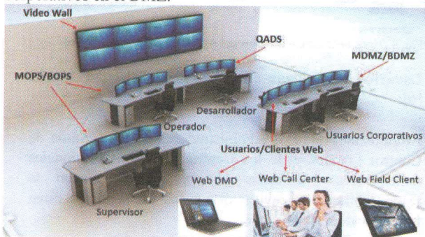
Fig. 9: Esquema de operación en un Centro de Control Local [8]. [Elaboración Propia].
