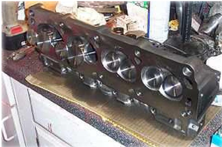
Fig 2.8 Culata de motor mecanizada en máquina transfer
