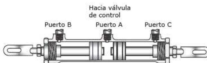
Fig 1.8 Cilindro de doble actuador
