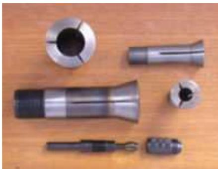
Fig 2.14 Pinzas cónicas portaherramientas
