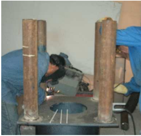
Fotografías 6-7. (Unión de los soportes a la placa base)
