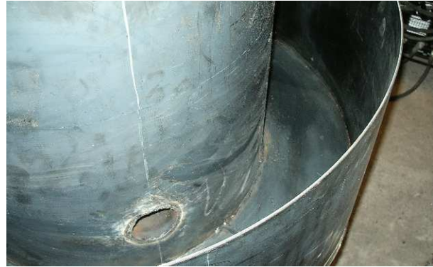
Fotografías 3- 4. (Toberas e interior de la caja de vientos)
