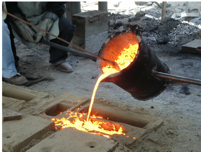
Fotografías 22. (Colación del metal en los moldes)
