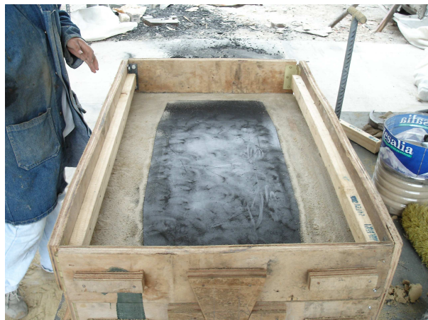
Fotografías 13-14. (Preparación de la arena y realización de los moldes)
