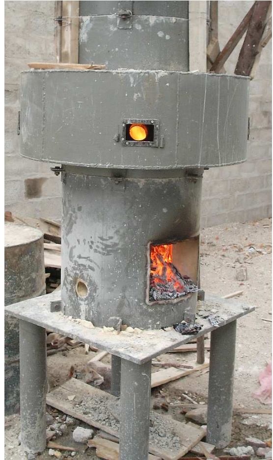
Fotografías 11-12. (Termino de la colocación del ladrillo y secamiento del horno)
