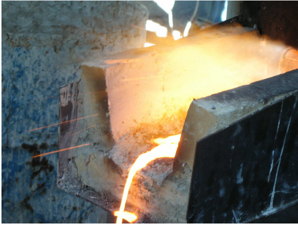
Fotografías 20 - 21. (Sangrado y recolección del hierro fundido)
