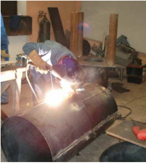
Fotografías 1- 2. (Soldadura y alineamiento de las etapas)
