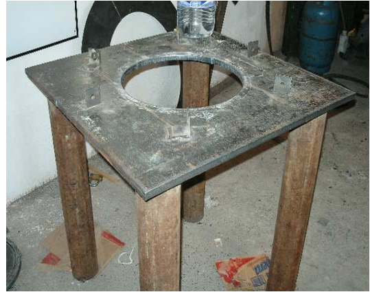
Fotografías 6-7. (Unión de los soportes a la placa base)
