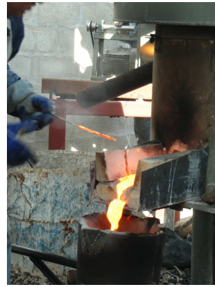
Fotografías 20 - 21. (Sangrado y recolección del hierro fundido)
