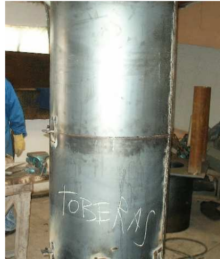
Fotografías 1- 2. (Soldadura y alineamiento de las etapas)
