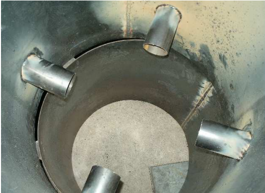
Fotografías 3- 4. (Toberas e interior de la caja de vientos)
