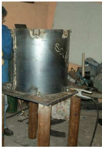
Fotografía 8. (Alineación de la etapa 1 a la base para la ubicación de los sujetadores)
