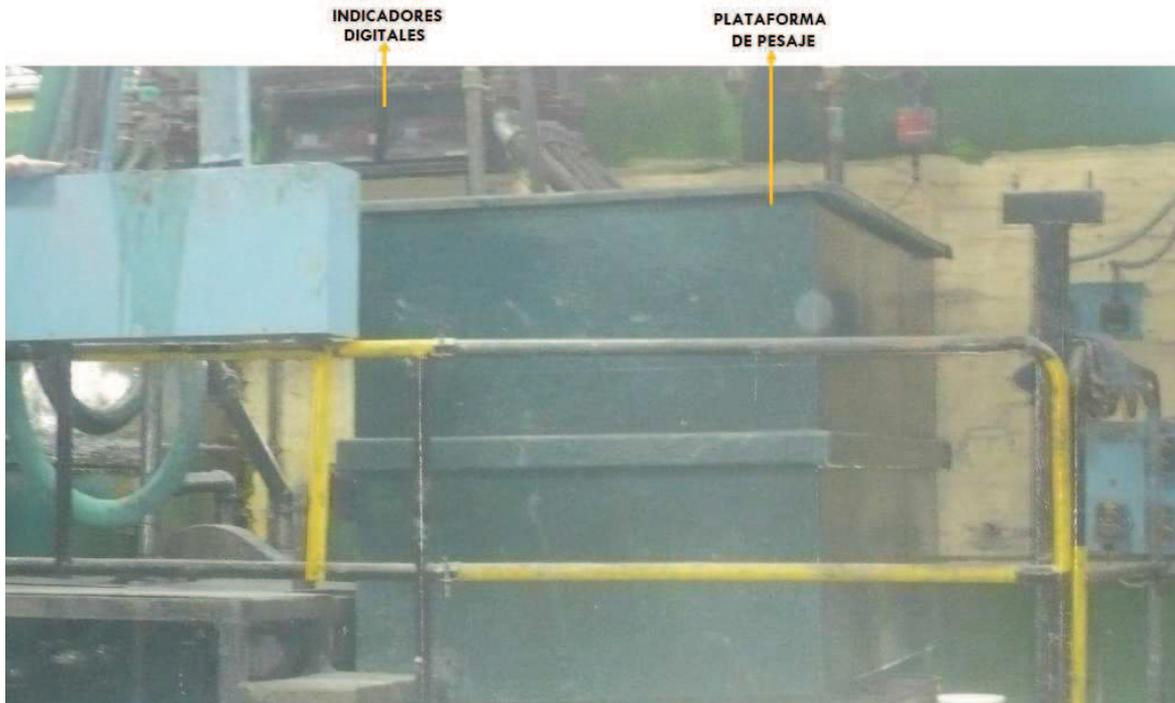
Figura1.4. Balanzas para Solventes
