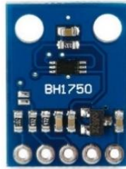
Figura 2.4 Sensor de Luz digital BH1750 [41]
