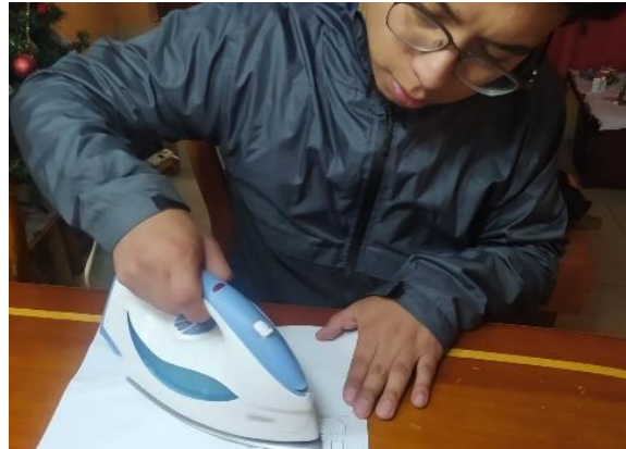
Figura 2.23 Transferencia térmica del circuito a la placa de fibra de vidrio FR4
