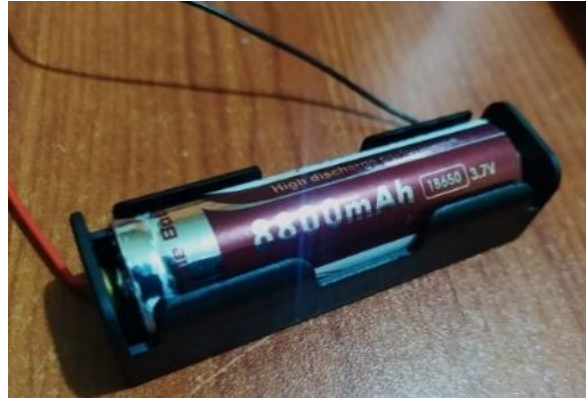
Figura 2.19 Pila recargable que alimenta la bomba de agua
