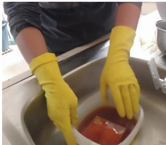
Figura 2.24 Proceso de quemado de la PCB
