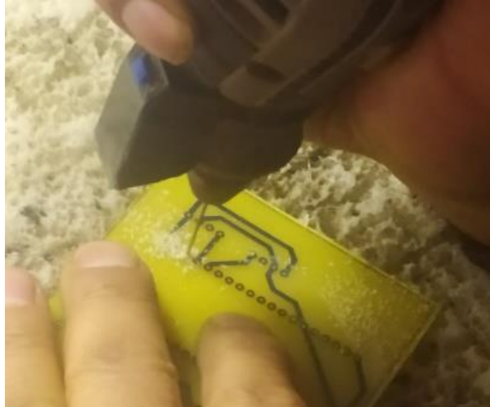
Figura 2.25 Protección del circuito impreso y perforación de los agujeros diseñados
