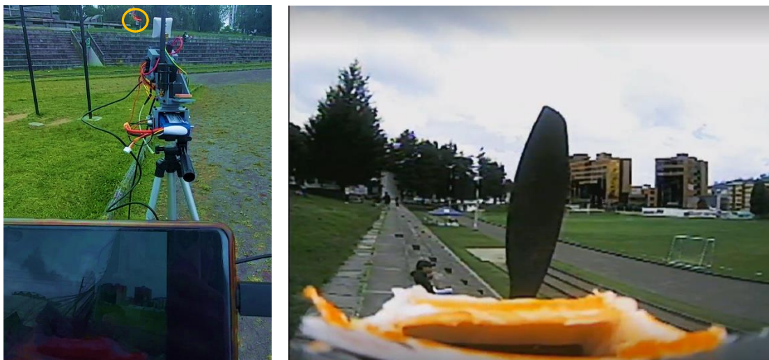
Figura 3.27 Prueba física del enlace de video entre la plataforma y el UAV.
