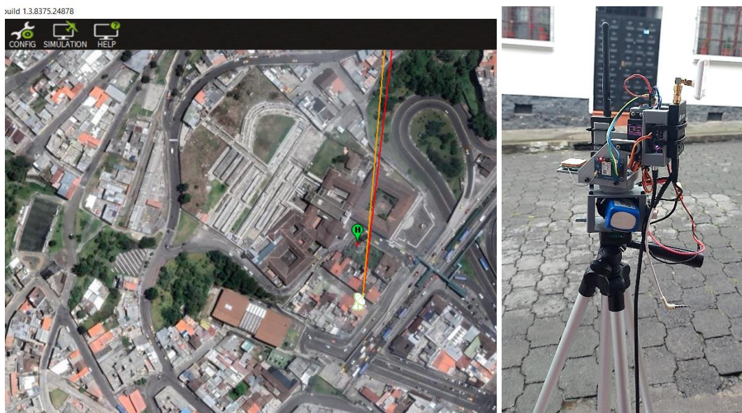
Figura 3.13 Ejemplo de apuntamiento virtual y físico de la estación terrena (misión parte frontal)
