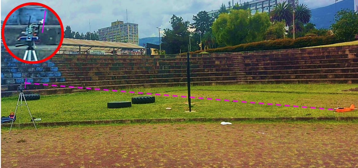
Figura 3.24 Apuntamiento automático de la estación terrena hacia el UAV.
