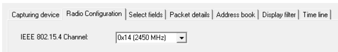
Figura 3.5 Sniffer capturando en el canal 20 de frecuencia
