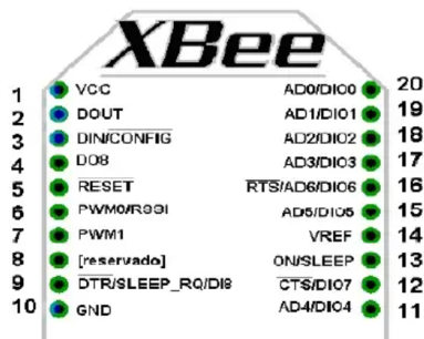
Figura 2.16. Distribución de pines módulo Xbee [22].
