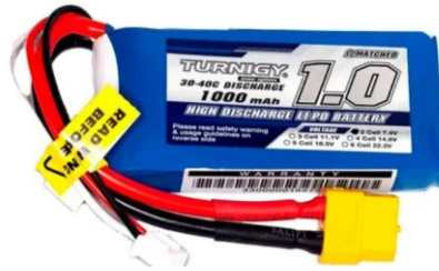
Figura 1.2. Batería Li-po de 7,4V [7]
