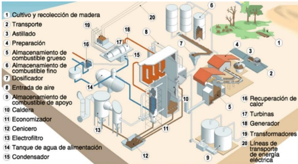
Figura 1.4. Partes constitutivas de una central de biomasa [10].
