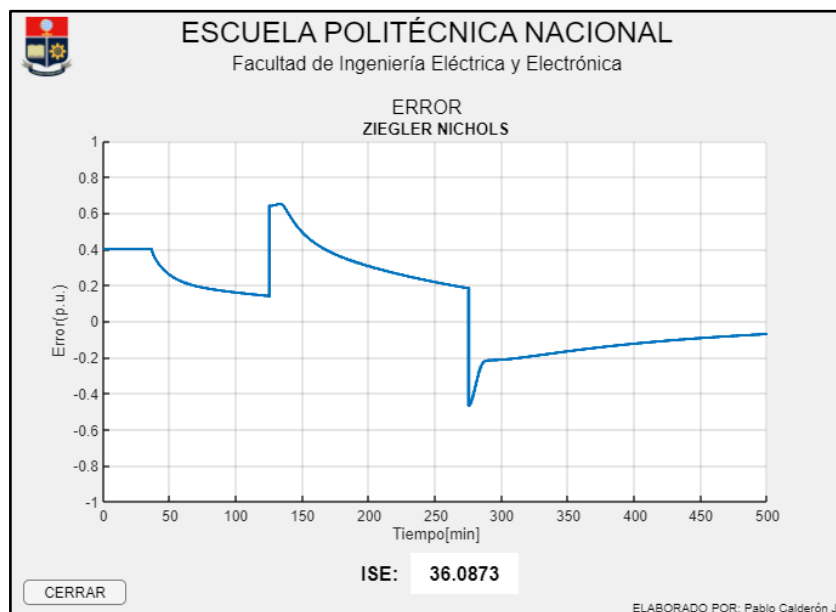
FIGURA 3.19 Error del sistema con controlador Ziegler Nichols frente a cambios de referencia
