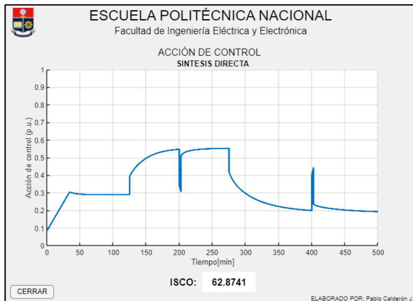
FIGURA 3.62 Salida del controlador Síntesis Directa frente a cambios de referencia y perturbaciones
