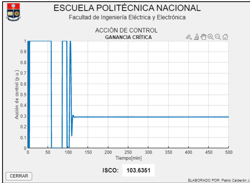
FIGURA 3.41 Salida del controlador Ganancia Crítica
