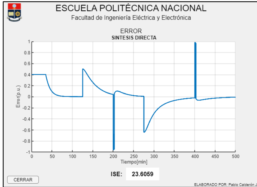
FIGURA 3.61 Error del sistema con controlador Síntesis Directa frente a cambios de referencia y perturbaciones
