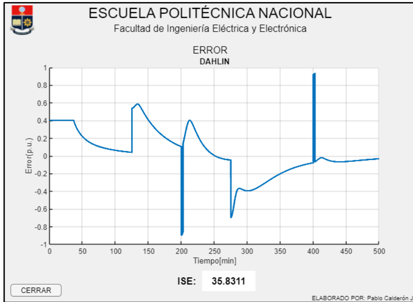
FIGURA 3.37 Error del sistema con controlador Dahlin frente a cambios de referencia y perturbaciones
