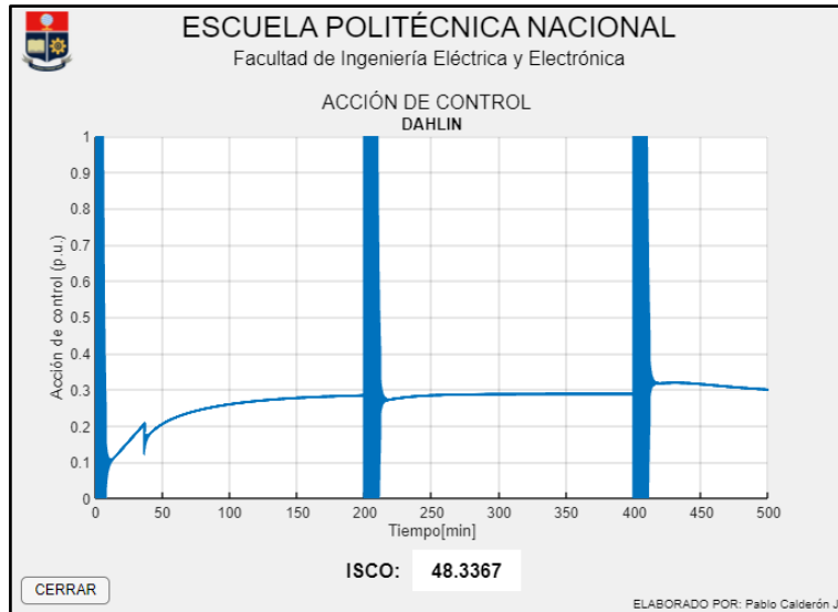
FIGURA 3.35 Salida del controlador Dahlin frente a perturbaciones
