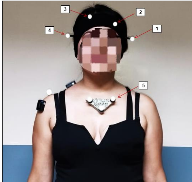
Figura 2.8. Vista frontal, marcadores colocados en la parte de cabeza y tronco. (Fuente: Propia)
