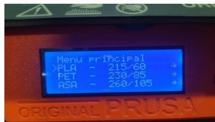
**Figura 3. 1** Temperaturas de boquilla y mesa en la impresora Prusa MK3S.
