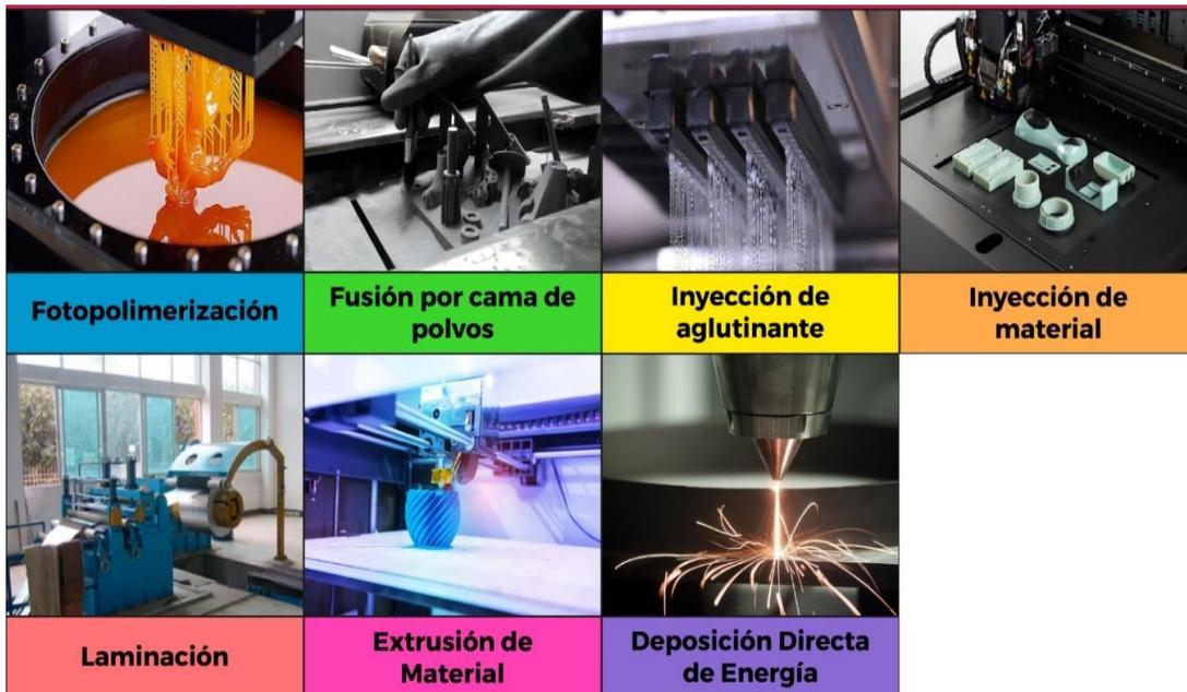
**Figura 1. 4** Tipos de manufactura Aditiva.
