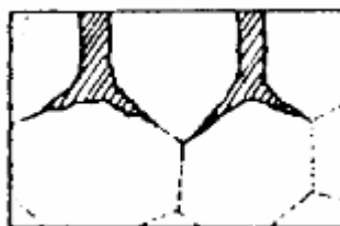
Fig. G. Corrosión Intergranular
