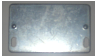
Probeta E. Recubrimiento de Cromo
