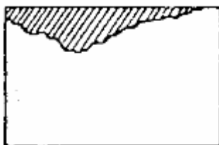
Fig. H. Corrosión por Placas
