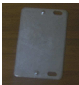
Probeta D. Recubrimiento de Níquel
