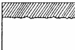
Fig. E. Corrosión Uniforme.
