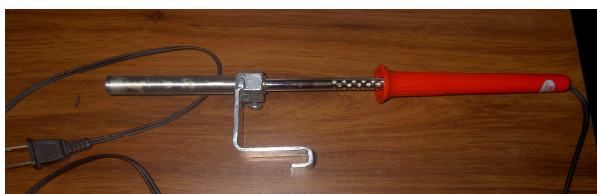
Calentador con soporte para Fijar en el borde de la Cuba
