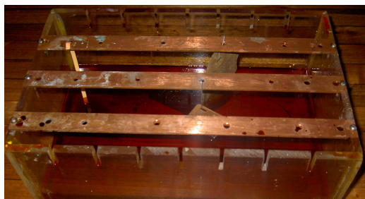
Sujeción de las piezas y ánodos a través de ganchos en las barras
