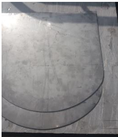
Figura 2.6. Moldes previos antes de la fabricación de las tapas de la tina. Fuente: Propia.
