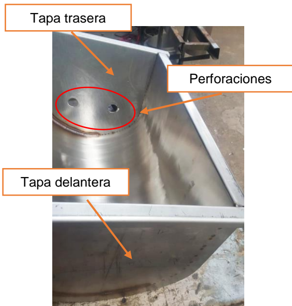
Figura 2.8. Perforaciones en tapa trasera para colocación de bujes. Fuente: Propia.
