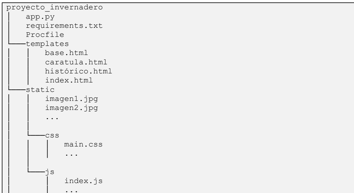
Script 2.7 Diagrama que muestra la estructura de archivos y carpetas para el proyecto.
