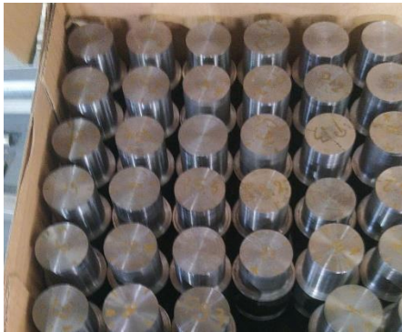
Figura 2.2. Probetas acero AISI 4140
