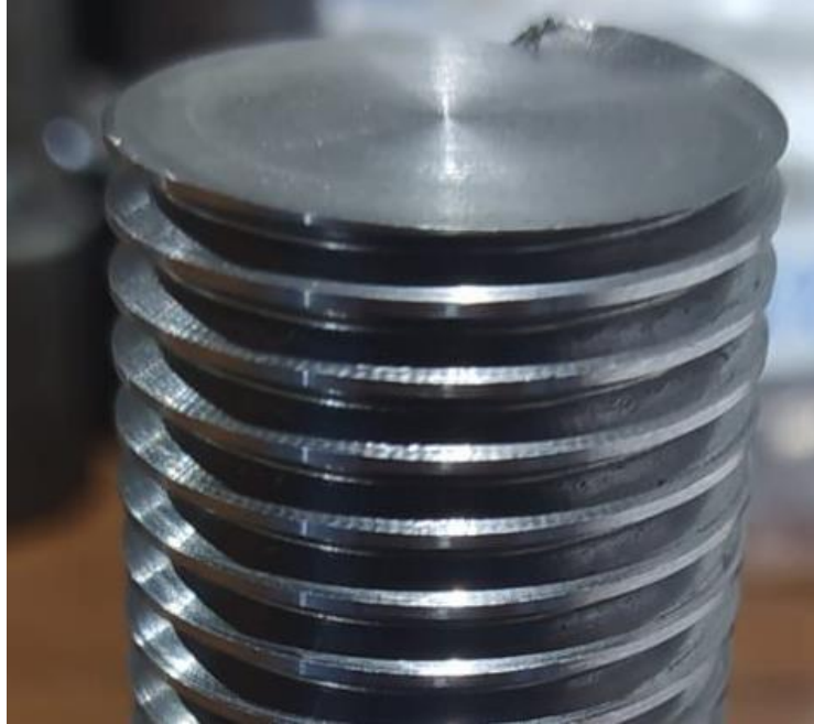
Figura 4.4. Presencia de flancos en las crestas de la probeta.
