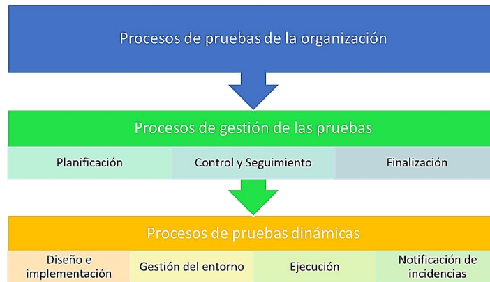
Figura 1.2 Modelo de pruebas definido en la norma ISO/IEC/IEEE 29119-2 [4].
