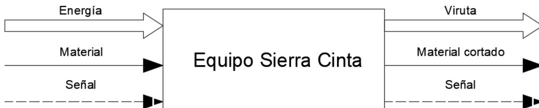
Figura 1.1 Diagrama de proceso de corte utilizando Sierra de Cinta.
