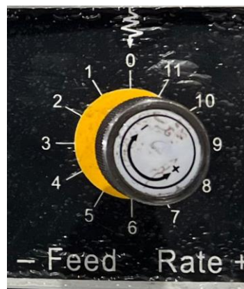
Figura 2.12 Control de velocidad de avance del Equipo BS - 1018B.
