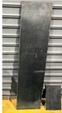
Figura 2.6 Material a cortar acero ASTM A36.
