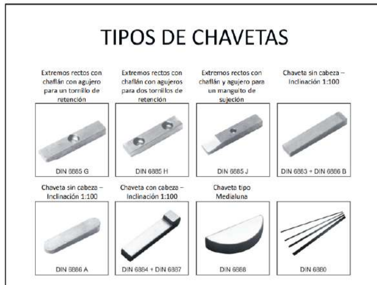
Figura 2.28. Tipos de chavetas Fuente: (EIS, 2011).
