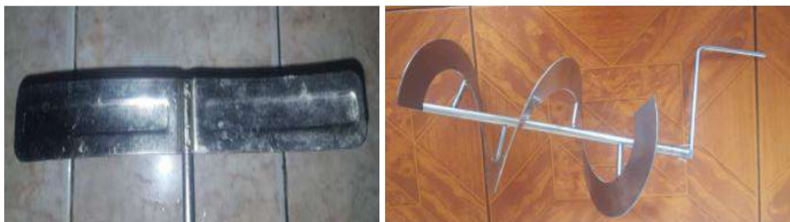
Figura 2.12. Prototipo construido del tornillo sin fin y de una hélice Fuente: Propia.
