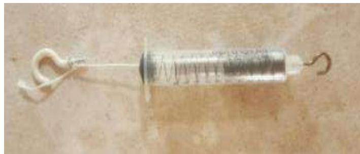
Figura 2.15. Dinamómetro casero Fuente: Propia.
