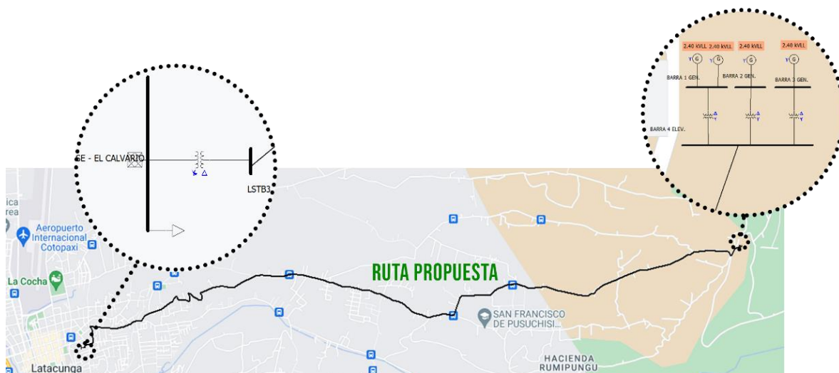
Figura 3.7. Trazado de la ruta propuesta de la línea actual Illuchi 1 – El Calvario en CYMDIST.
