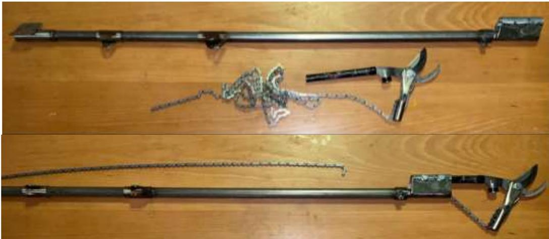
**Figura 3.2.** Unión mecanismo de corte al mecanismo de extensión.
