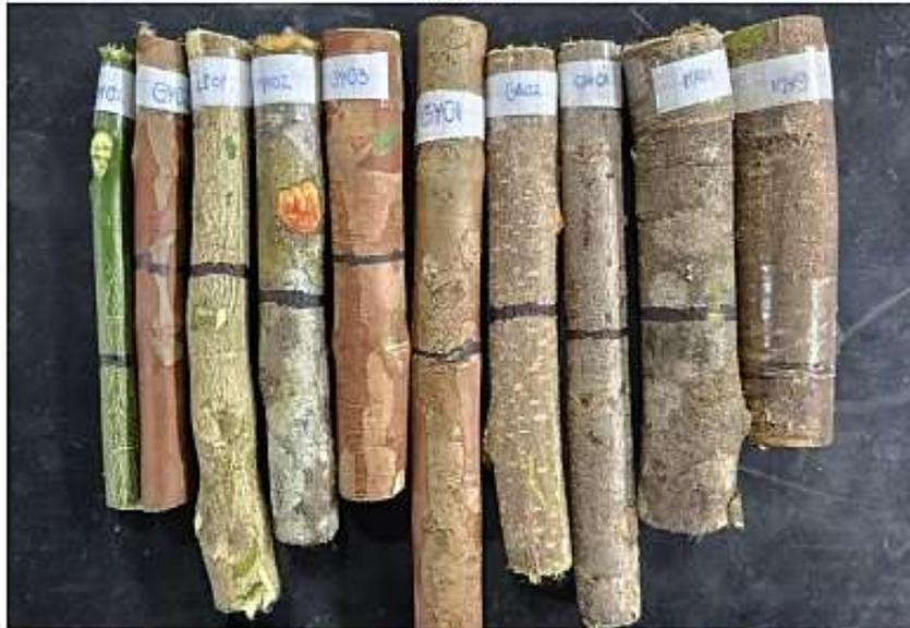
Fotografía 1. Muestras para ensayo de corte simple.
