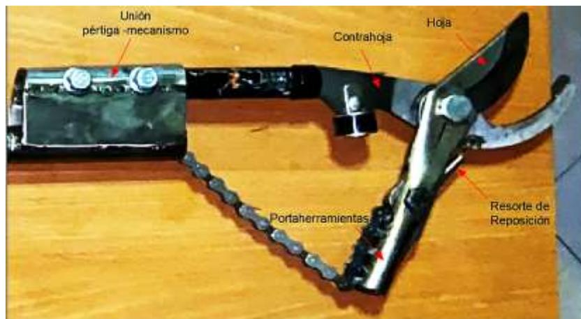
**Figura 3.7.** Partes del mecanismo de corte.
