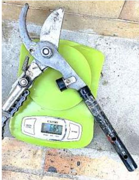
**Figura 3.9.** Peso del mecanismo de corte en gramos.
