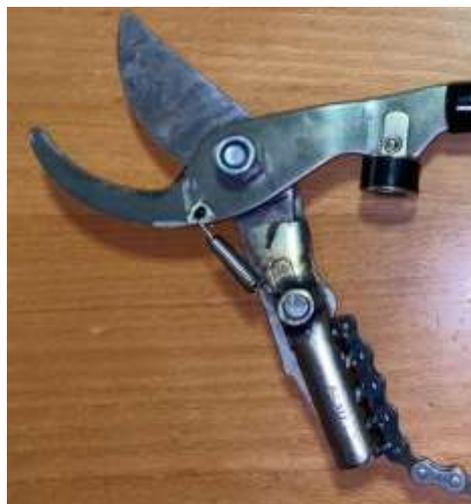
**Figura 3.8.** Resorte y cadena anclados al portaherramientas.
