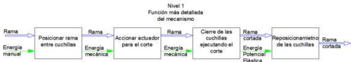
**Figura 2.2.** Nivel 1: Funciones ejecutadas por el mecanismo.
