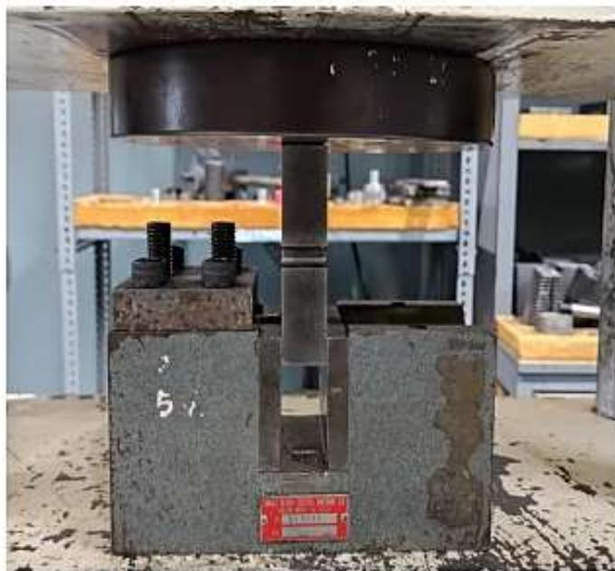
Fotografía 2. Montaje de la muestra para ensayo de corte.
