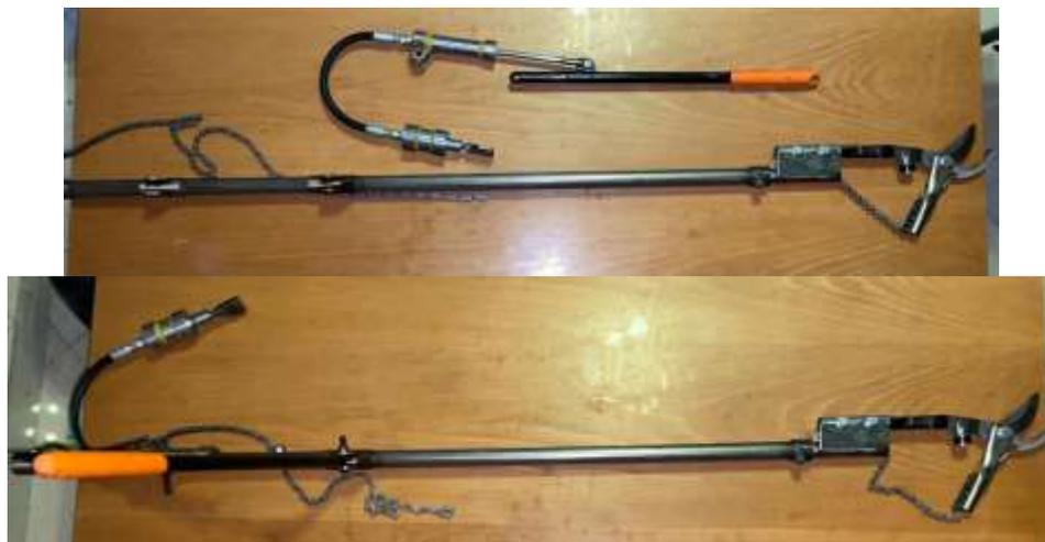
**Figura 3.3.** Unión del mecanismo hidráulico al mecanismo de extensión.
