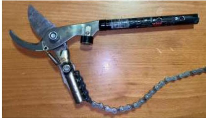
**Figura 3.1.** Unión mecanismo de corte a la cadena.
