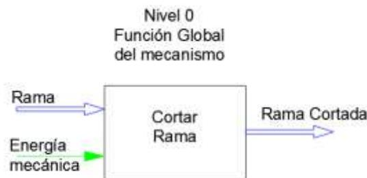
**Figura 2.1.** Nivel 0: Funcionamiento global del mecanismo.
