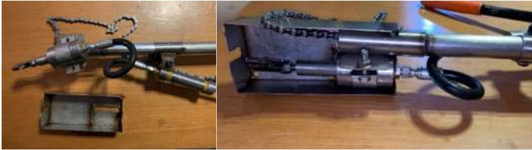
**Figura 3.4.** Incorporación del cilindro actuador y mecanismo de extensión de extensión a la caja de transmisión.
