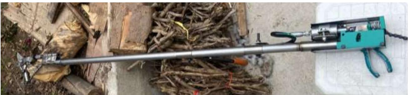
**Figura 3.6.** Podadora Hidráulica Manual Ensamblada.
