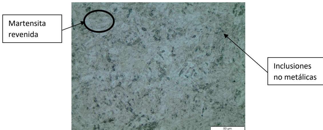
Figura 3.12. Metalografía óptica a 100 x con tratamiento térmico de temple y doble revenido, con ataque químico: Marble. Muestra 22-034M (TR) (Fuente: Propia)
