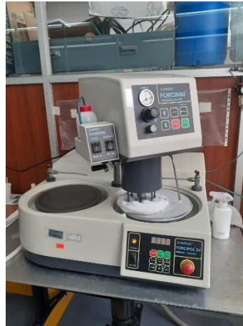
Figura 2.11. Proceso de pulido con paño de 1 micra y aspersion de diamante (líquido) de 1 micra. (Fuente: Propia)
