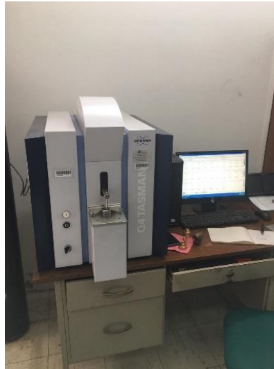
Figura 2.16. Espectrómetro de chispa. (Fuente: Propia)
