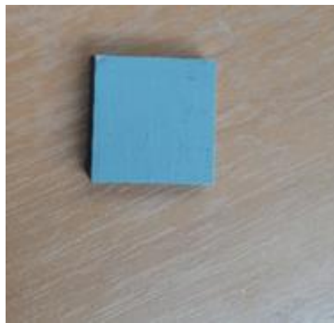
Figura 2.7. Probeta de 20x20 [mm] usada para el ensayo de dureza. Cod: 22-034 D (Fuente: Propia)
