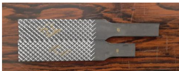
Figura 3.6. Probeta T2 con tratamiento térmico de temple y doble revenido. (Fuente: Propia)
