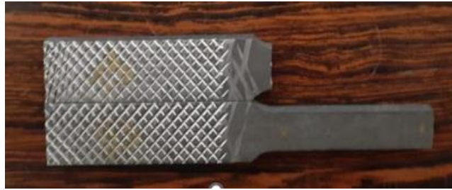
Figura 3.7. Probeta T3 con tratamiento térmico de temple y doble revenido. (Fuente: Propia)
