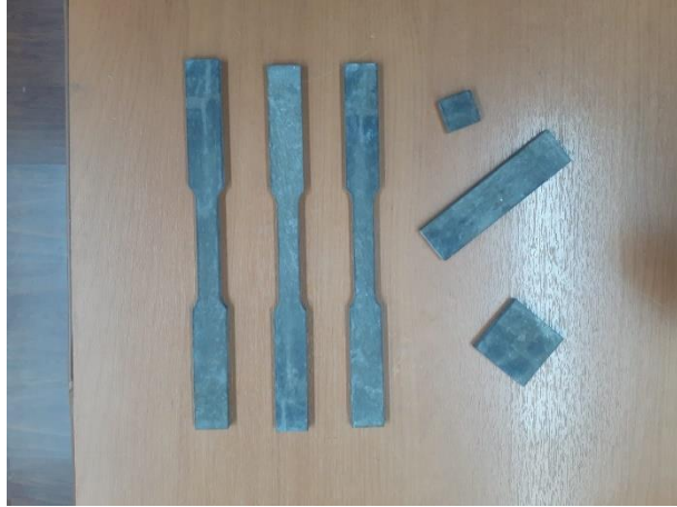
Figura 2.17. Probetas AISI 420 templadas y con doble revenido. (Fuente: Propia)
