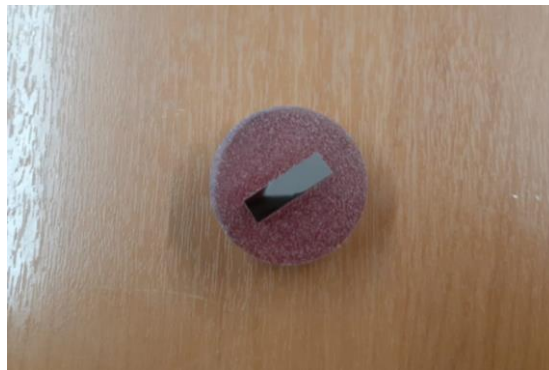
Figura 2.12. Se puede observar la probeta luego del proceso de desbaste y pulido sin marcas, lista para ser atacada químicamente. Cod:22-034M. (Fuente: Propia)
