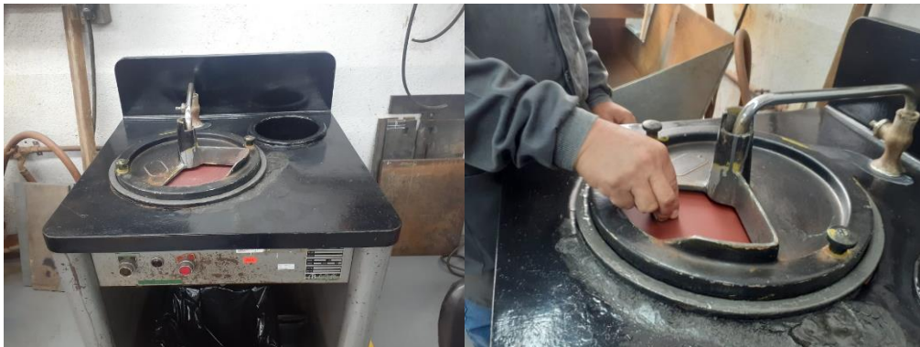
Figura 2.9. Desbastadora y proceso de desbaste grueso (lija#100). (Fuente: Propia)
