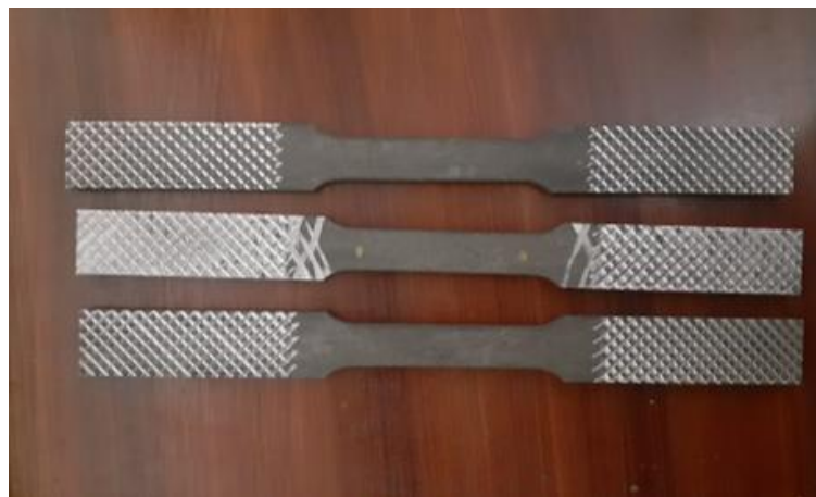
Figura 2.6. Probetas con tratamiento térmico de temple y doble revenido, moleteado para mejor agarre en la zona de fijación. (Fuente: Propia)
