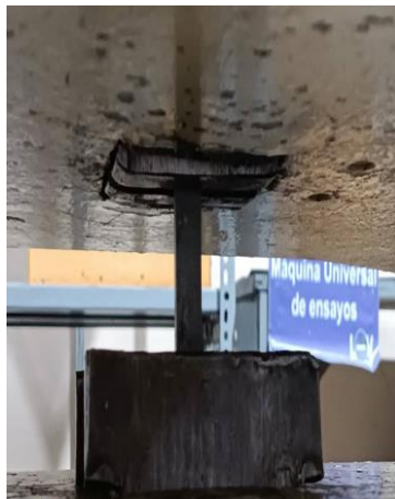
Figura 2.4. Montaje de la muestra para ensayo de tensión (Máquina universal de ensayos) (Fuente: Propia)
