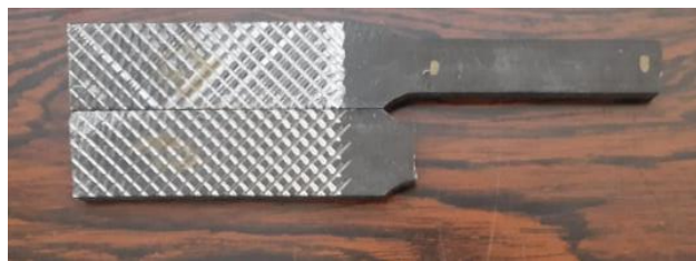
Figura 3.5. Probeta T1 con tratamiento térmico de temple y doble revenido. (Fuente: Propia)
