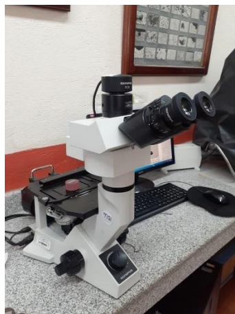
Figura 2.13. Muestra 22-034 M montada en el microscopio metalográfico. (Fuente: Propia)
