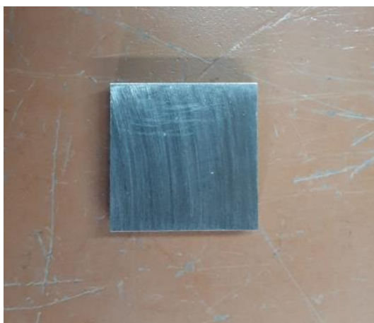
Figura 2.15. Probeta para el ensayo de espectrometría de chispa (composición química). (Fuente: Propia)
