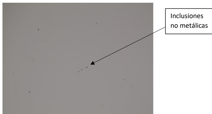
Figura 3.9. Metalografía óptica a 100x en su condición de fábrica sin ataque químico. (Fuente: Propia)
