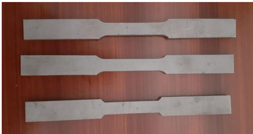
Figura 2.2. Probetas para el ensayo de tensión. Material AISI 420 en su condición de fábrica. (Fuente: Propia)
