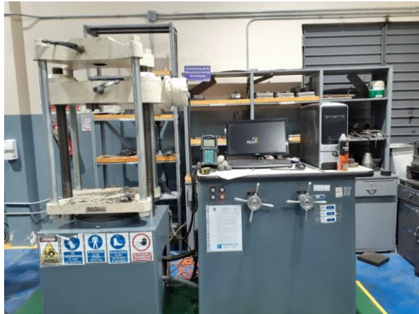
Figura 2.3. Máquina Tinius Olsen. Usada para el ensayo de tensión. (Fuente: Propia)
