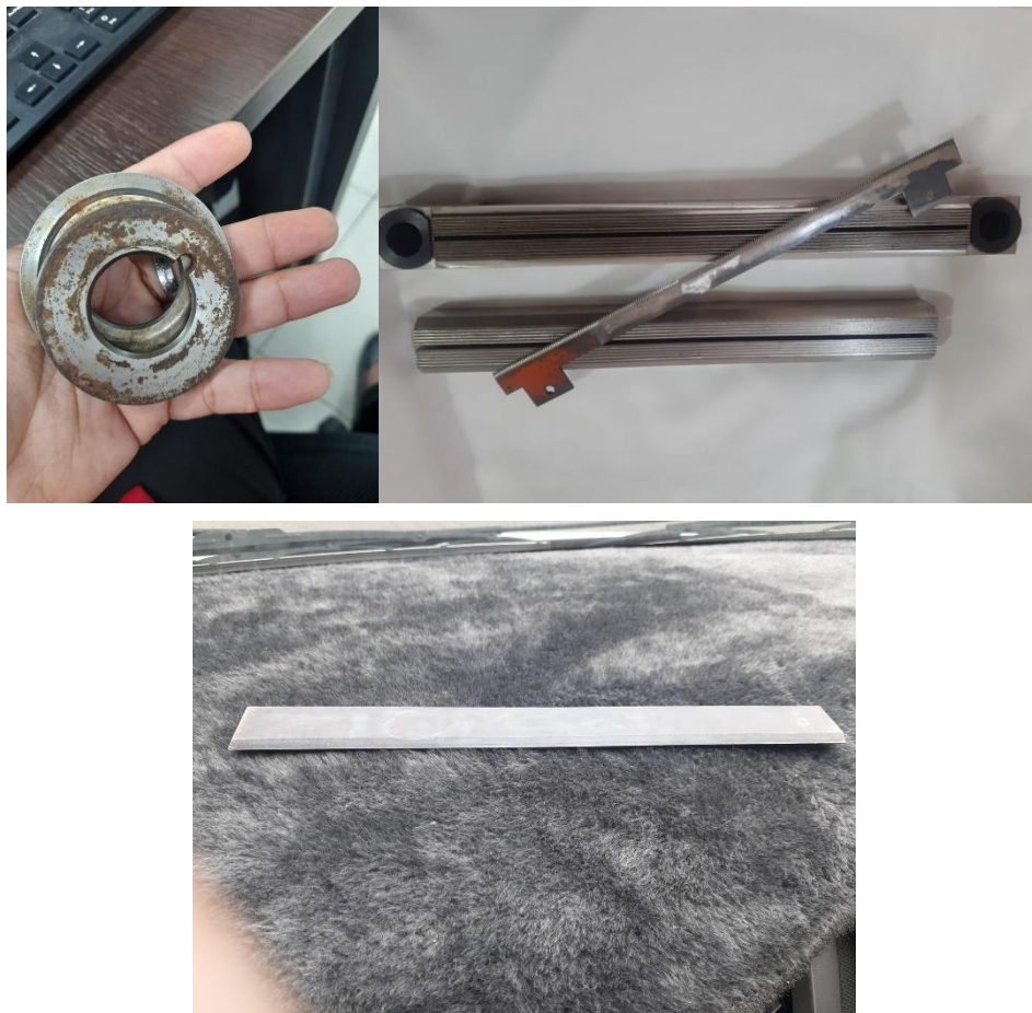
Figura 1.2. Tipos de cuchillas, redonda, dentada, recta echas de acero DF2 templado se puede observar en la cuchilla redonda el óxido. (Fuente: Propia)
