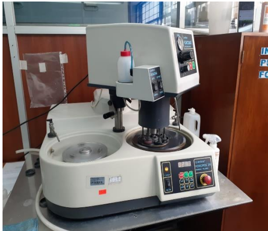
Figura 2.10. Equipo para preparación y pulido de muestras para análisis metalográfico. (Fuente: Propia)
