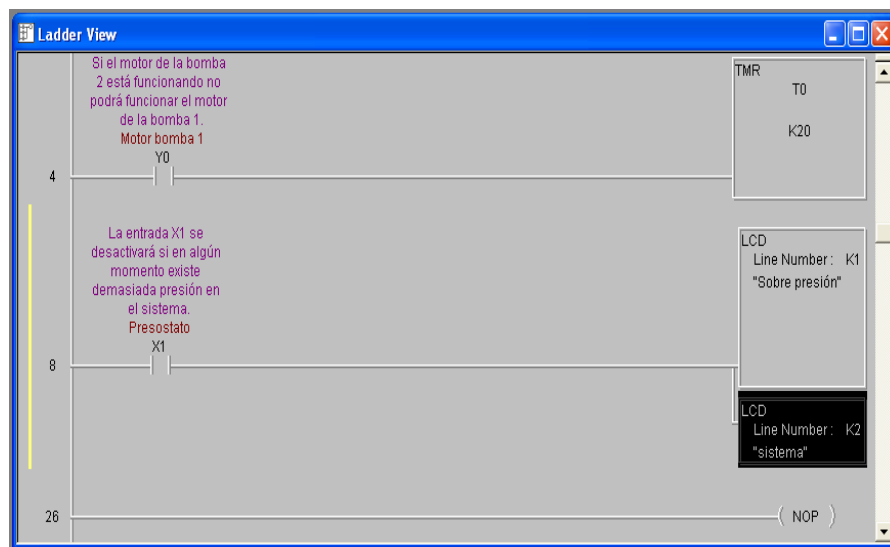
Fig.3.16: Programa con un temporizador y una salida LCD
