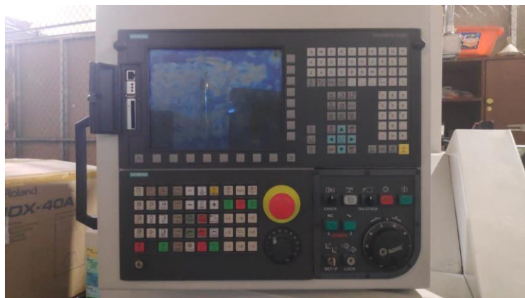
Figura 3.6. Unidad de control del torno CNC ROMI C420.
