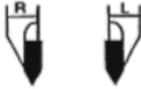
Figura 3.8. Herramientas de widia para roscado.
