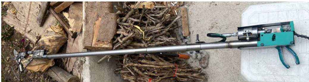
Fig. 26: Pértiga de Poda: Integración Componentes Potencia, Corte, Extensión y Transmisión. Fuente: Propia
