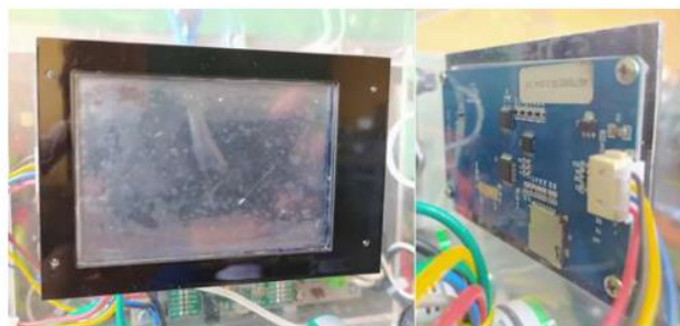
Figura 22. Conexión de la pantalla Nextion dentro del GOV. [2]
