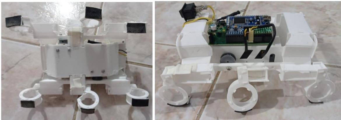
**Figura 3.6** Mejora en el sistema de tracción de las patas. (Fuente propia)
