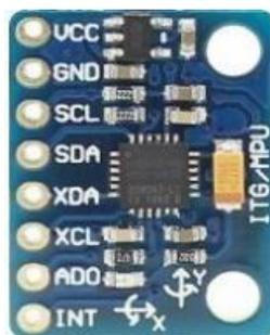
**Figura 2.17** Distribución de pines del MPU6050. (Fuente [28])
