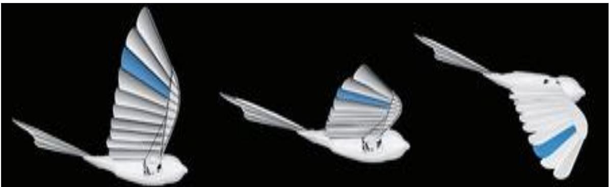
**Figura 1.6** Robot volador llamado BionicSwift de la marca Festo empleado para investigaciones de robótica. (Fuente [14])
