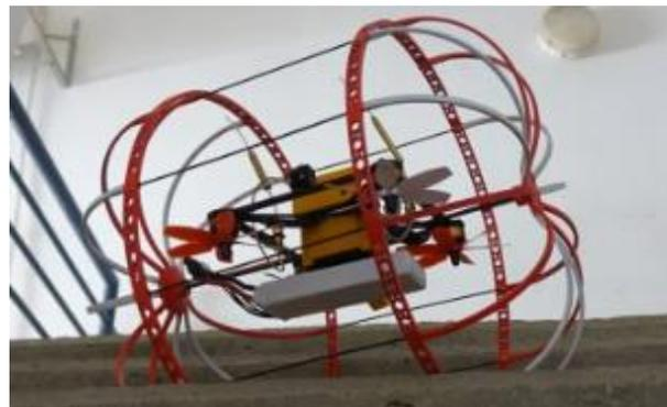
**Figura 1.4** Robot Gallo creado por la empresa RoboTiCan el cual se usa con el fin de encontrar víctimas en riesgo luego de una catástrofe natural. (Fuente [12])
