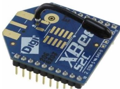
**Figura 2.14** Módulo XBee DigiMesh 2.4. (Fuente [23])
