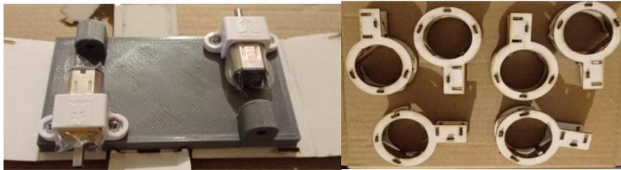
**Figura 2.5** Anclaje de las piezas en 3D sobre el chasis para simular el peso de la plataforma. (Fuente propia)
