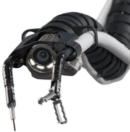
**Figura 1.5** Robot tipo serpiente llamado Flex Robotic System creado por el grupo Medrobotics empleado para la exploración del colon, procedimientos médicos y hasta intervenciones quirúrgicas. (Fuente [12])
