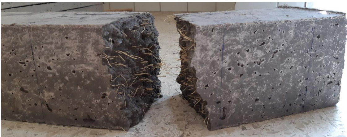
Figura 33. Ensayo de resistencia a la flexión en vigas
