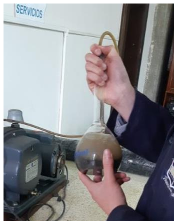
Figura 12. Ensayo de peso específico del agregado fino
