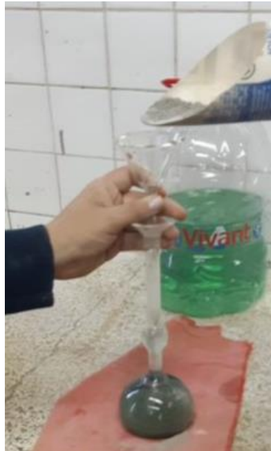
Figura 9. Ensayo densidad real del cemento
