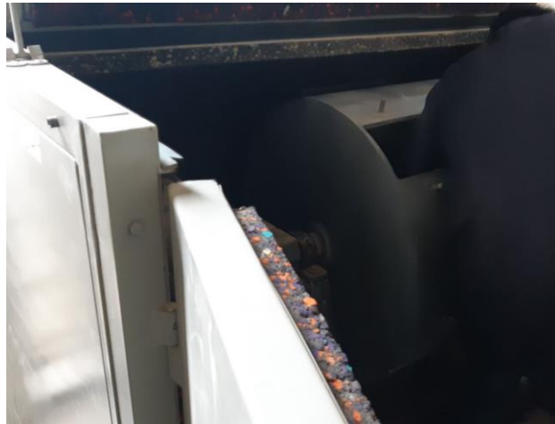
Figura 11. Ensayo en la máquina de los Ángeles
