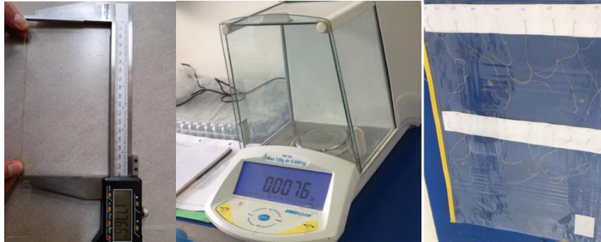
Figura 18. Medida de largo y masa de las fibras de palma africana
