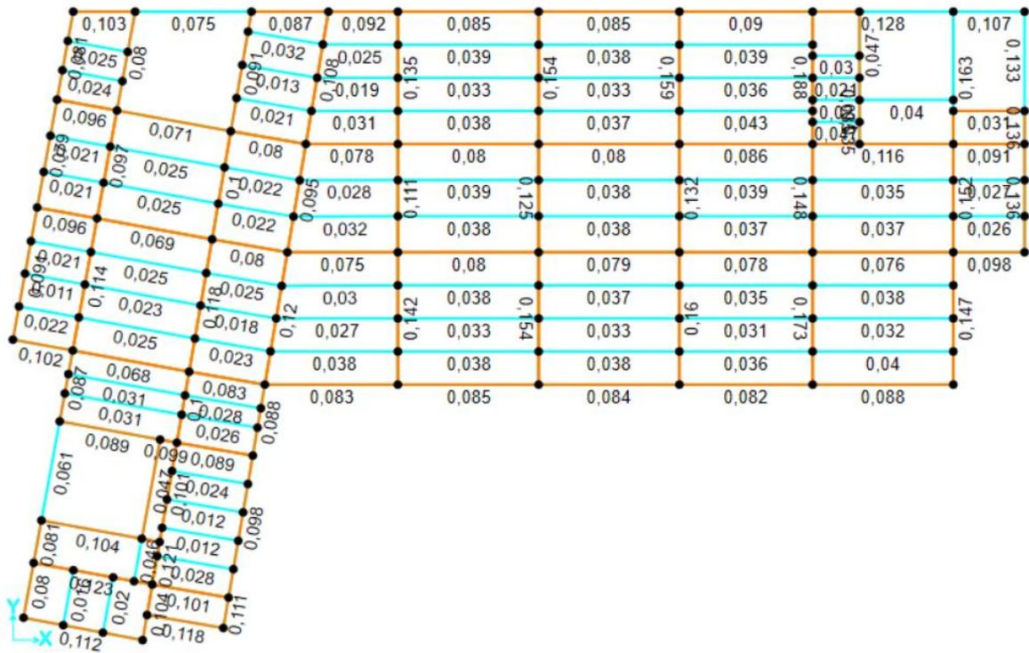
Figura 30. Factores de uso de la estructura (Plano X-Y)
