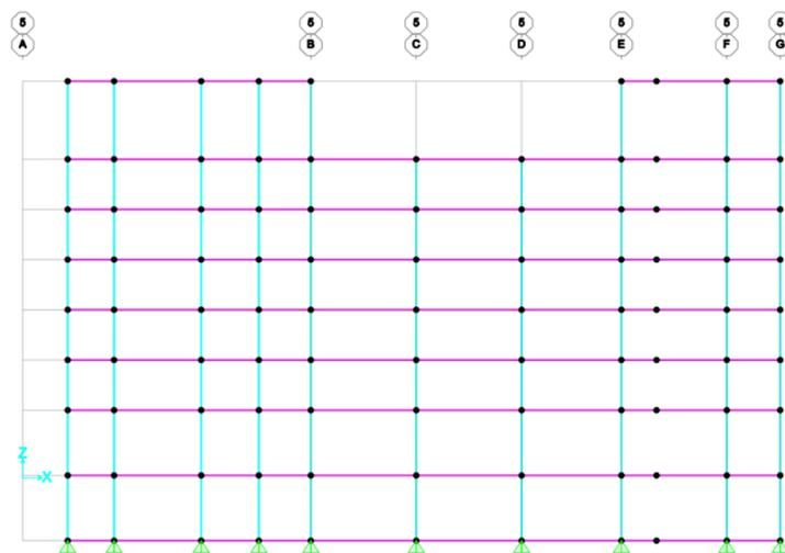
Figura 22. Creación de las columnas en el eje XZ en SAP2000
