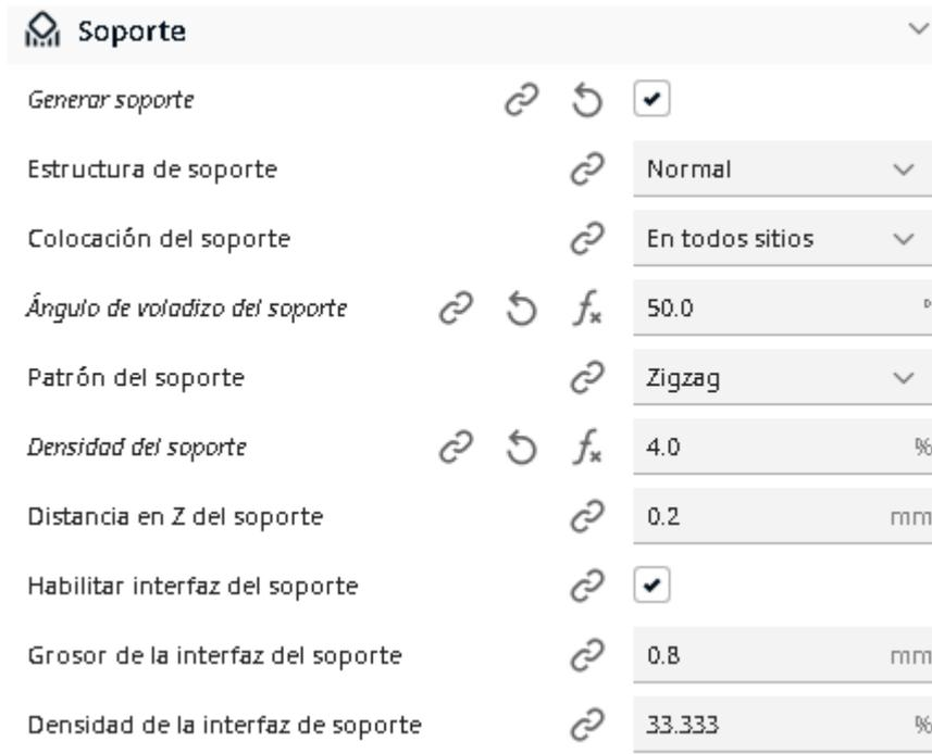
**Figura 2.15.** Parámetros para soportes para PLA y TPU.
