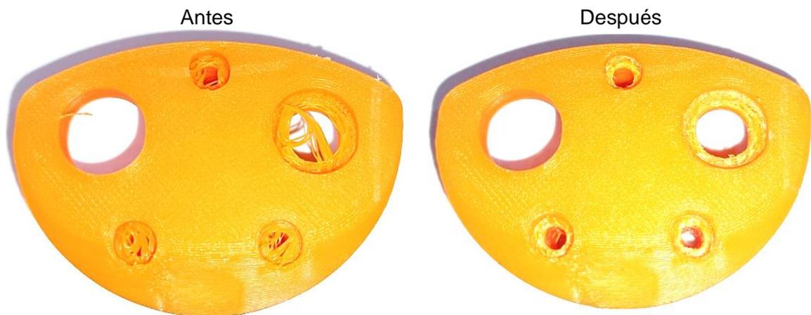
**Figura 2.19.** Ejemplo de postproceso del elemento G en filamento PLA.
