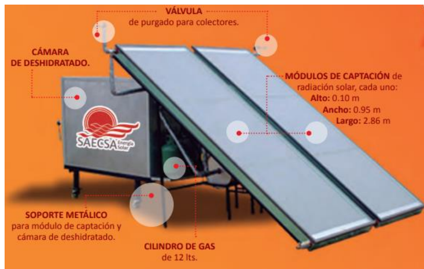
Figura 4.2.11. Deshidratador solar semi - industrial. (SAECSA, 2013)
