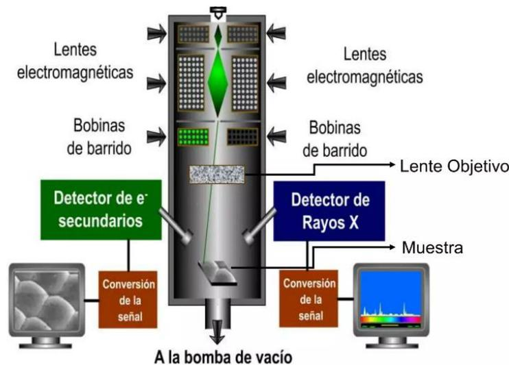
**Figura 1.13.** Mecanismo de la Microscopía Electrónica de Barrido (SEM) [8].
