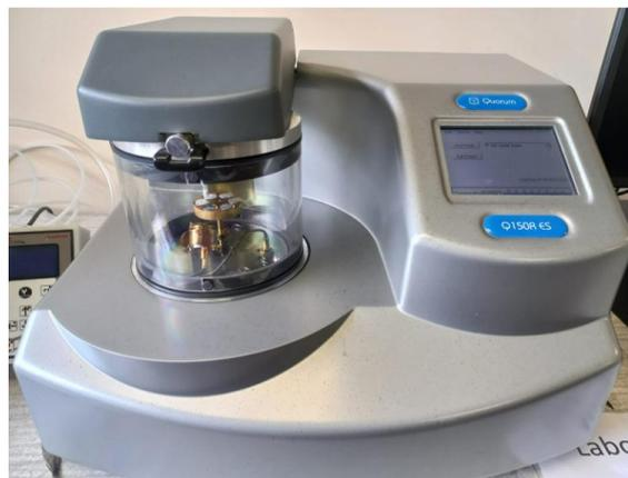
**Figura 2.73.** Recubrimiento metálico de las muestras con un equipo de PVD.
