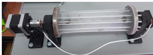
**Figura 2.54.** Sistema de recolección de la máquina de electrohilado NANOTECH.
