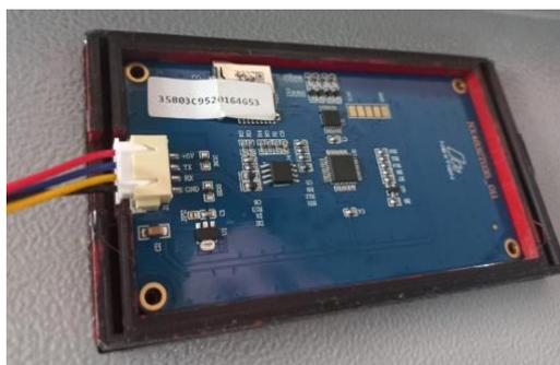
**Figura 2.62.** Conexiones a la pantalla Nextion.
