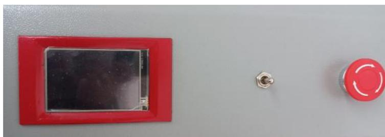
**Figura 2.68.** Implementación de la pantalla Nextion, el switch de encendido y apagado, y el pulsador de emergencia en la carcasa de la máquina de electrohilado.
