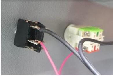
**Figura 2.63.** Conexiones al switch y pulsador de emergencia.
