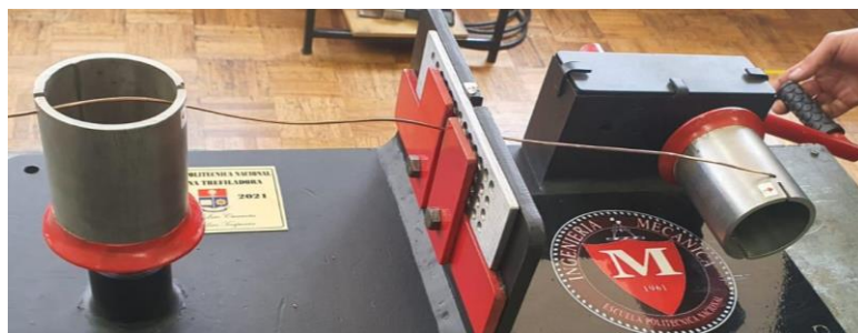
Figura 2.4 Sujeción del alambre en el tambor giratorio de la trefiladora
