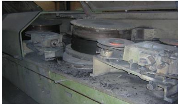
Figura 1.5 Trefiladora de tiro directo-júpiter [3]
