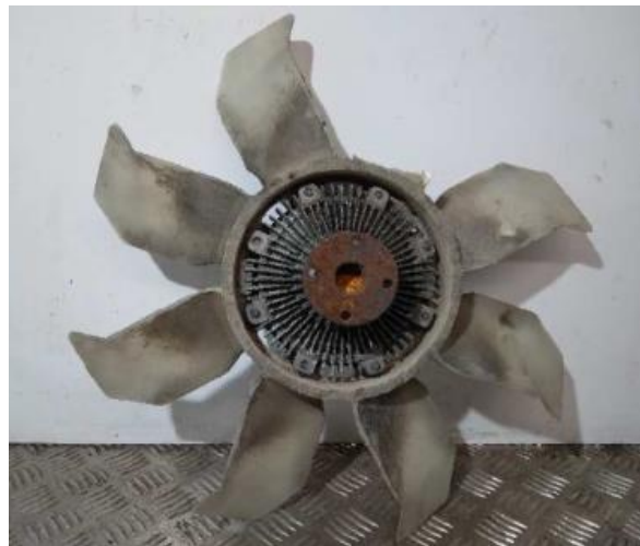
Figura 1.1. Ventilador de motor con aspa rota.
