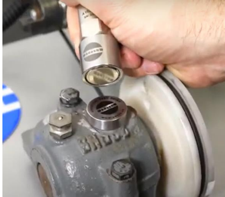
Figura 2.6. Montaje del sensor en la máquina.
