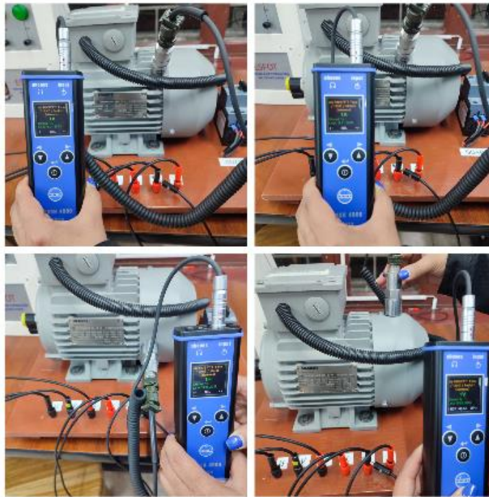
Figura 2.21. Mediciones manuales con analizador de vibraciones.
