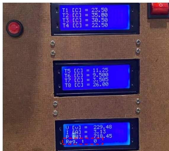
Figura 24. Display de temperaturas en banco de pruebas.
