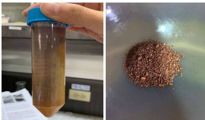
(c) Muestra en el proceso de centrifugado. (d) Muestra después de la calcinación.
