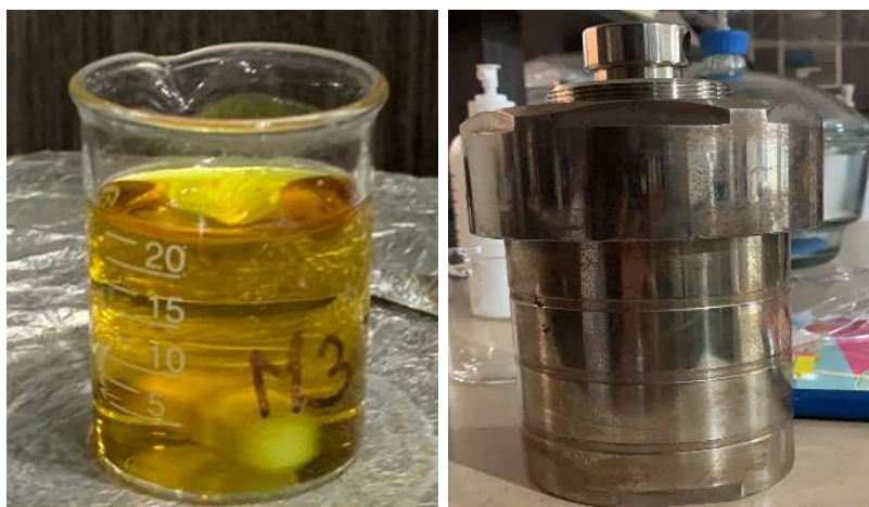
(a) Mezcla de los precursores en la solución de glicol etileno y agua. (b) Autoclave con la muestra después del tratamiento hidrotérmico.
