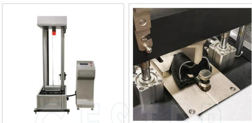
**Figura 3.** Probador de impacto de calzado de seguridad GESTER modelo GT-KB17 [7]
