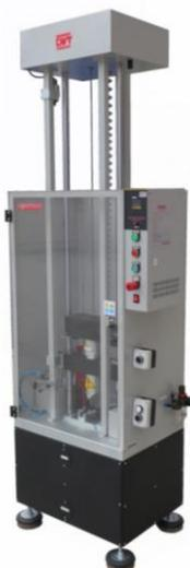
**Figura 4.** Probador de impacto de puntera de calzado de seguridad DEVOTRANS DVT SAHA [8]
