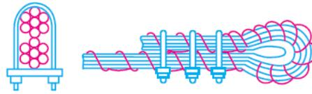
**Figura 21.** Gaza de cable con fijación por tres sujetacables [9]
