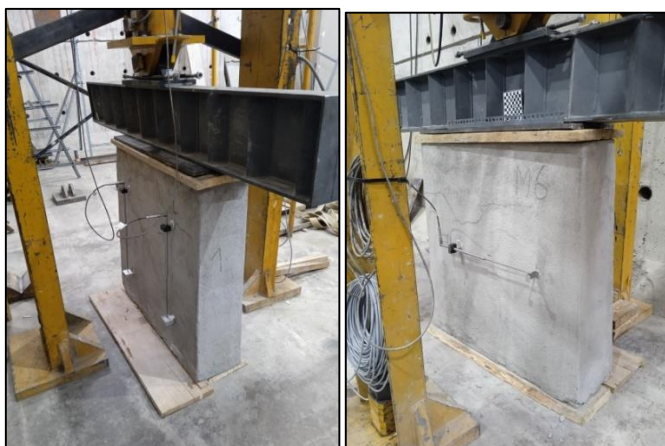
Figura 61: Instrumentación de muretes con reforzamiento
