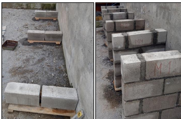
Figura 26: Elaboración de muretes sin reforzamiento
