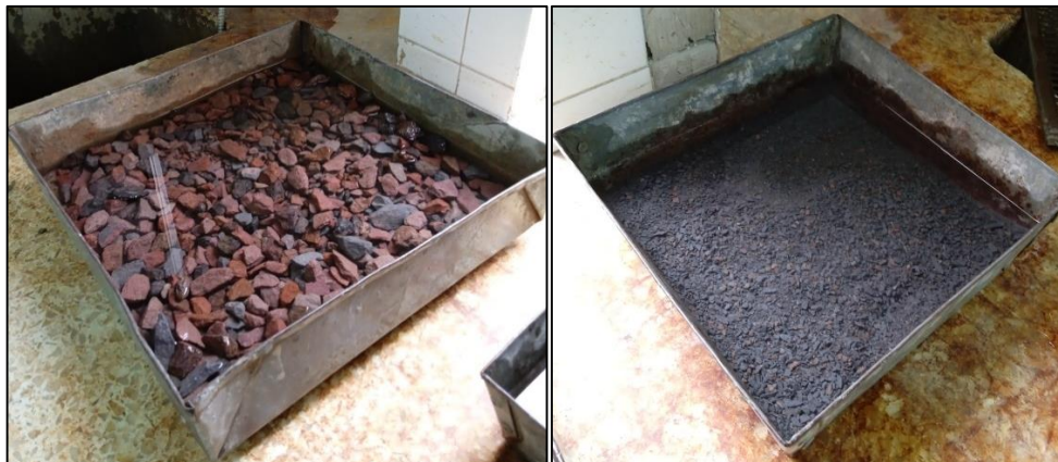
Figura 18: Agregado fino y grueso, tratado en laboratorio
