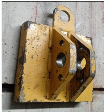
Figura 55: Acople de muro
