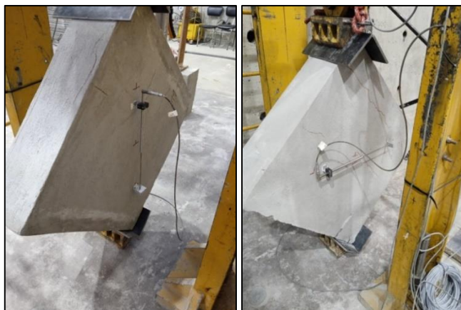
Figura 67: Instrumentación de muretes con reforzamiento
