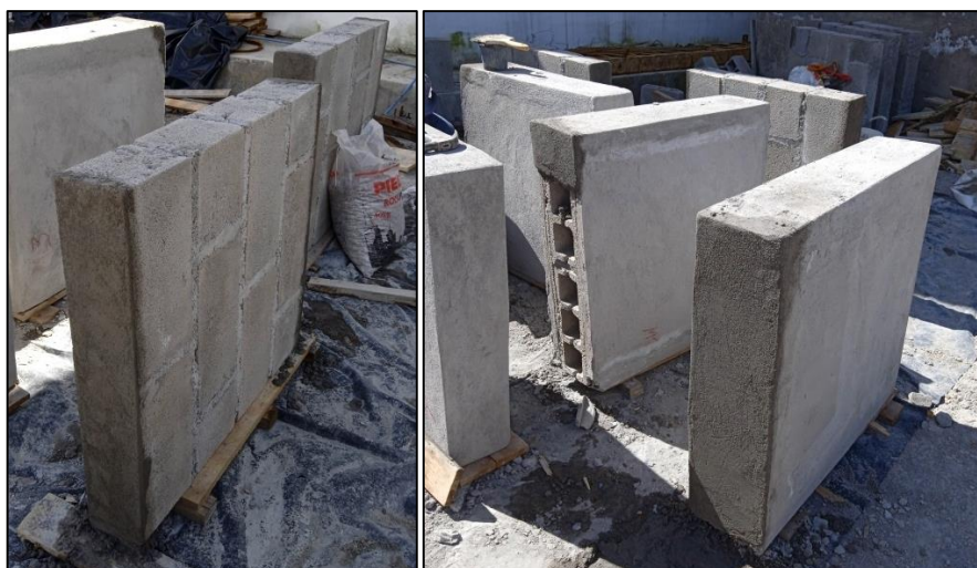
Figura 29: Enraizado para ensayo a compresión y tensión diagonal
