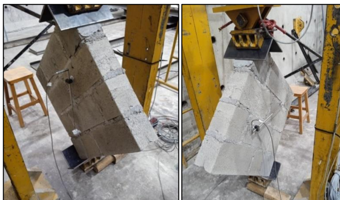
Figura 66: Instrumentación de muretes sin reforzamiento
