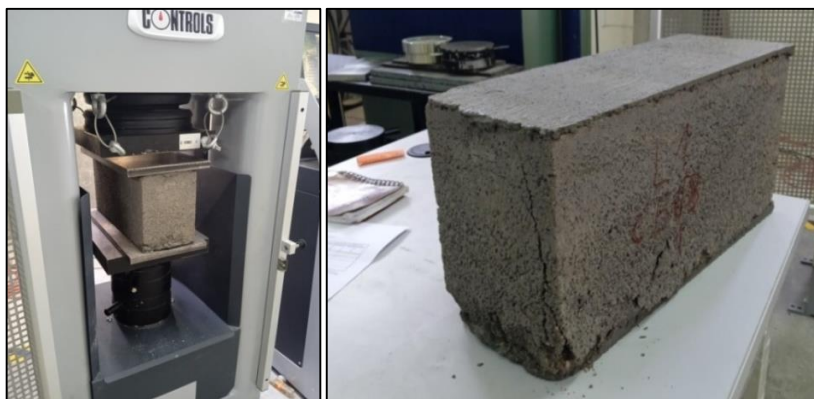
Figura 23: Bloque de hormigón ensayado a compresión
