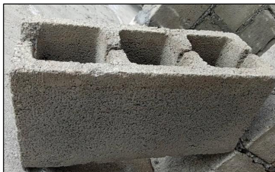
Figura 19: Bloque de hormigón tipo B
