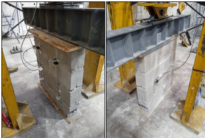
Figura 60: Instrumentación de muretes sin reforzamiento
