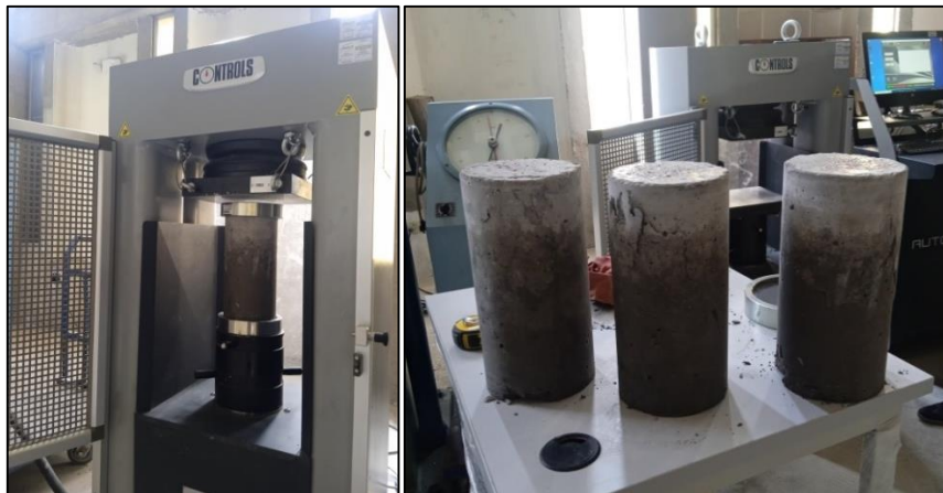
Figura 25: Cilindros de hormigón ensayados a compresión
