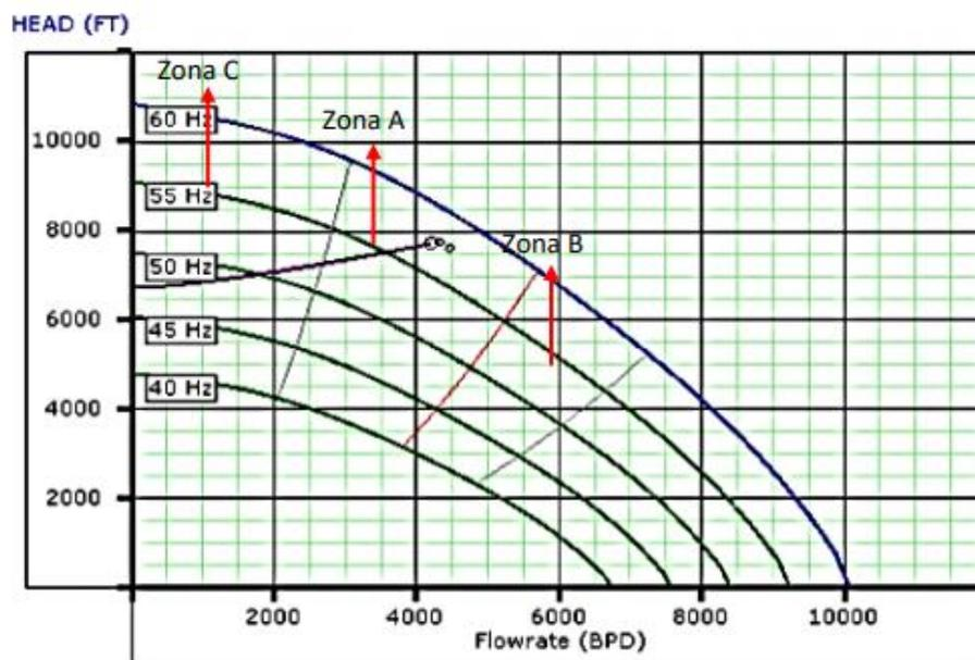
**Figura 2.6** Curva Tornado de Bomba Electrosomergible
