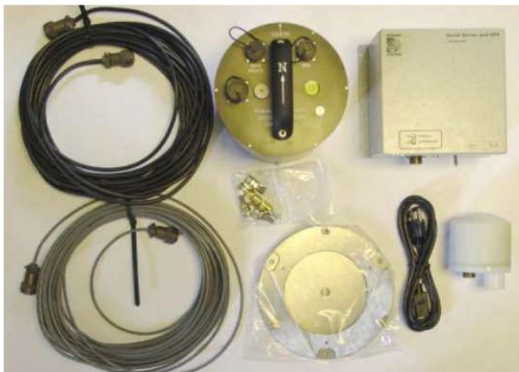
**FIGURA 39** Equipo CMG-5T Triaxial Accelerometer. Ubicado en la estación QUIB.
