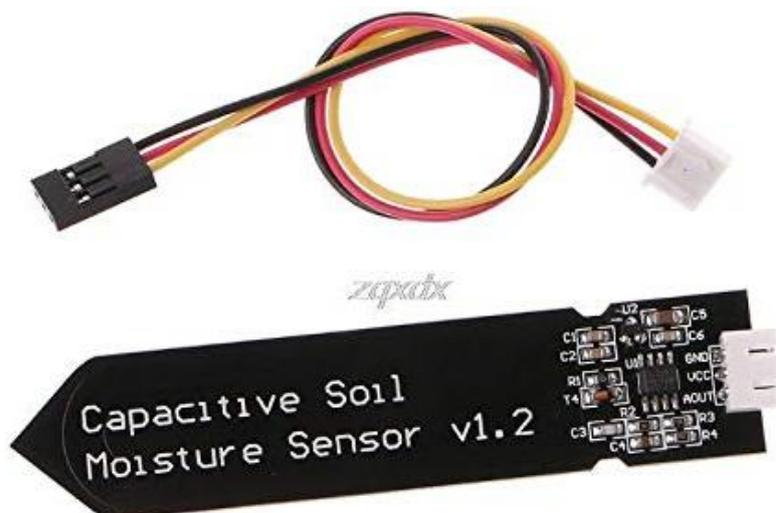
Figura 2.26 Sensor Capacitivo de Humedad [71]
