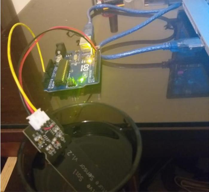
**Figura 3.13** Pruebas a sensor de humedad de suelo con Arduino
