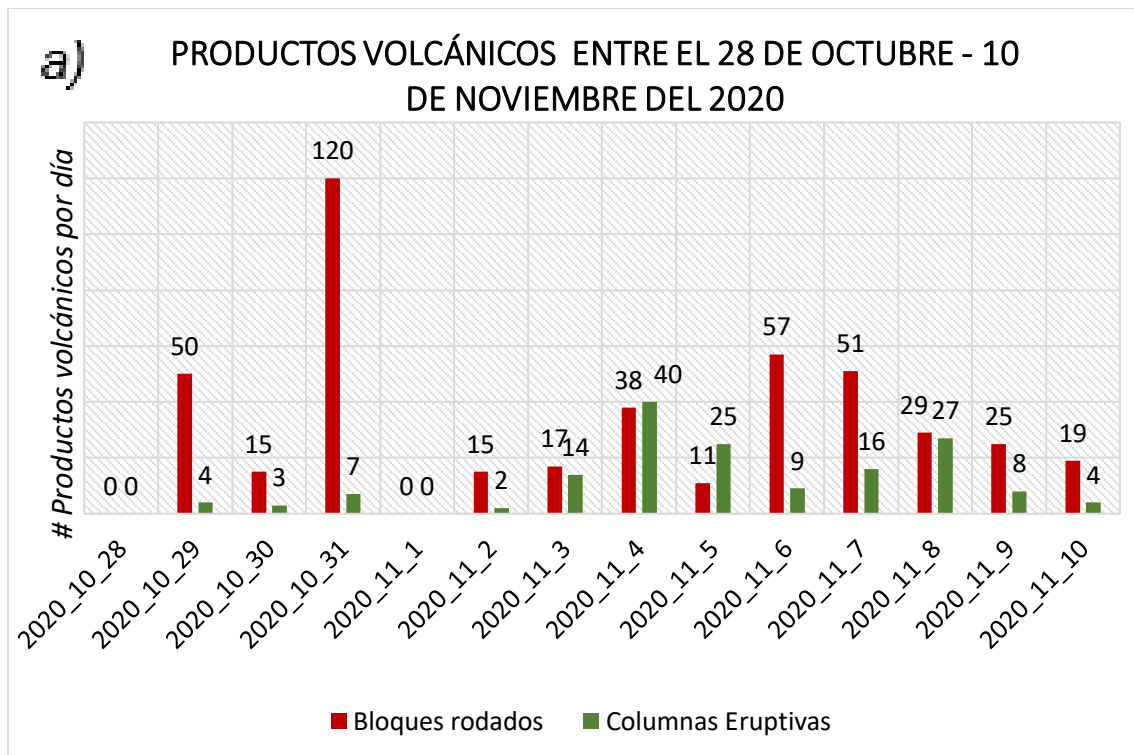
Figura 5.4a) Representación del número de columnas eruptivas y bloques rodados registrados por día dentro del periodo de estudio 28 de octubre-10 de noviembre del 2020 obtenidos por la cámara visual REBECA.
