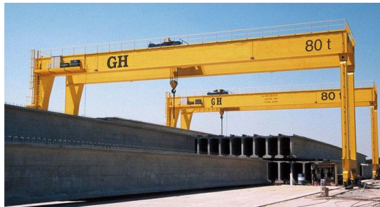
Figura 1.2 Puente grúa con configuración empotrada – articulada [8].
