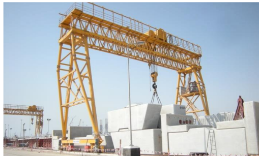
Figura 1.5 Puente grúa con pórtico en celosía [8].
