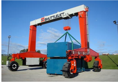
Figura 1.4. Puente grúa con pórtico móvil [8].
