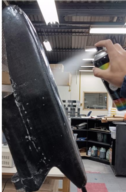
Figura 2.70. Aplicación de capa protectora.
