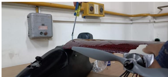
Figura 2.21. Proceso de ensamblaje manual de prototipos de aeronaves en el laboratorio de UAVs.
