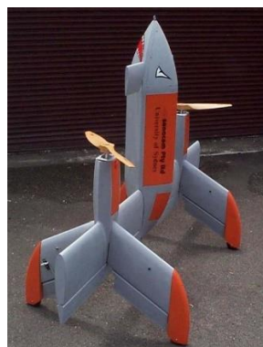
Figura 1.4. Tail sitter UAV modelo T-Wing utilizado para aplicaciones civiles.
