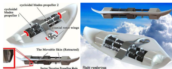
Figura 1.5. Configuración y renderizado del VTOL combinando cuchillas cicloidales y propelas de hélices de ventilador.
