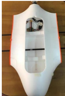
Figura 1.13. Fuselaje de SkyWalker fabricado por extrusión.
