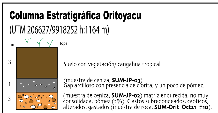
Figura 4.8 Columna estratigráfica elaborada en la vía lastrada a Oritoyacu. Visitado el día 21 de octubre del 2021 con Msc. Patricia Mothes, Ing. Josué Salgado e Ing. Marco Córdova. (UTM 206627 / 9918252 h: 1164m).
