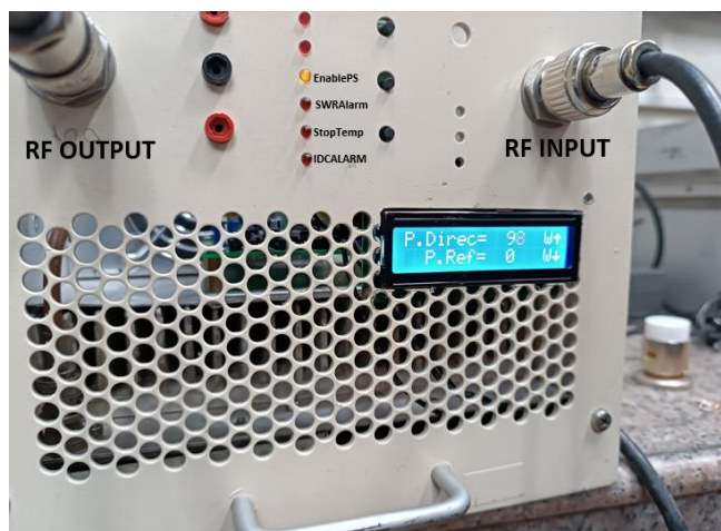
Figura 3.12 Conexión de la señal de radio frecuencia al amplificador de potencia
