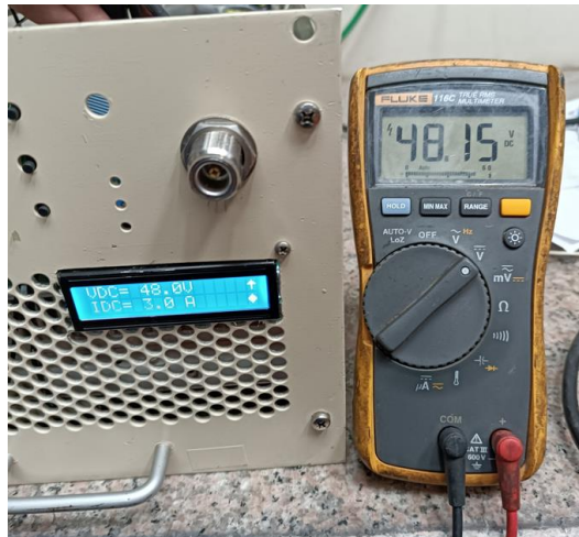
Figura 3.6 Medición de voltaje DC
