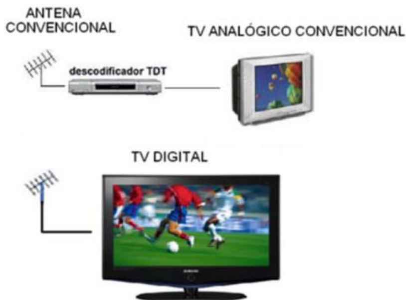
Figura 1.8. Sistema de recepción de la TDT [51]
