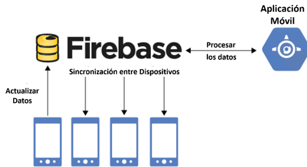
Figura 2.7.1 Esquema de la relación de la base de datos Firebase con la aplicación
