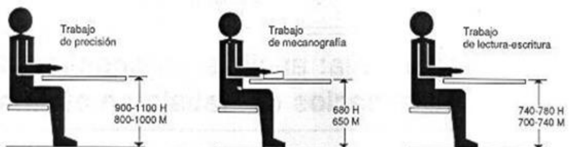
Figura 2.4. Altura del plano de trabajo según NTP 242
